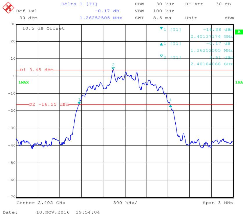
**EDR ( $\pi/4$ -DQPSK): Middle Channel**
