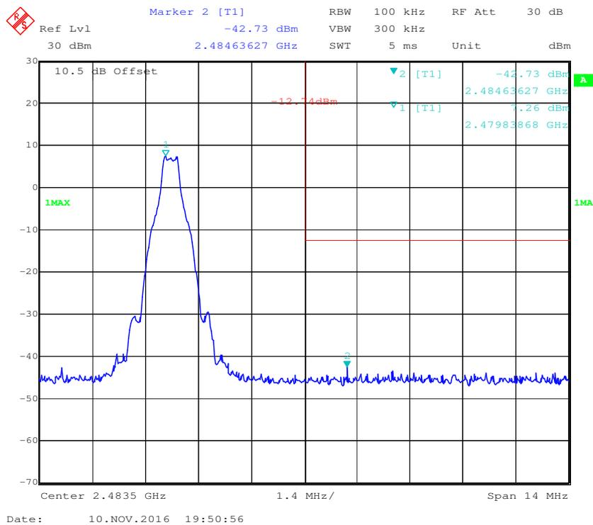
**EDR ( $\pi/4$ -DQPSK): Band Edge-Left Side**
