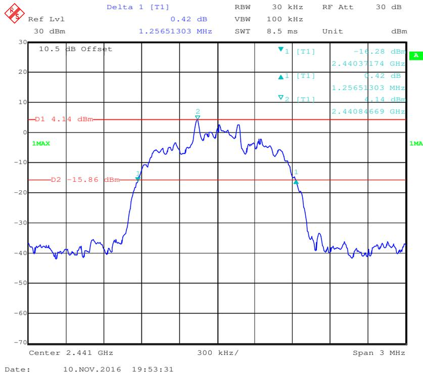
**EDR ( $\pi/4$ -DQPSK): High Channel**
