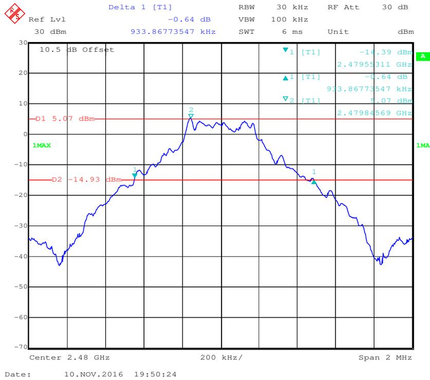
**EDR ( $\pi/4$ -DQPSK): Low Channel**
