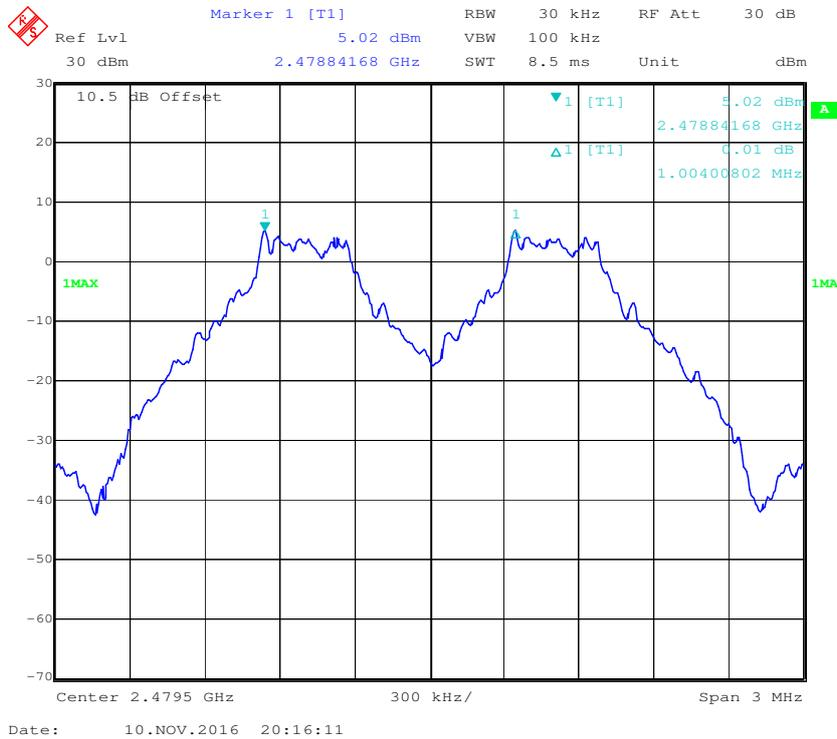
**EDR ( $\pi/4$ -DQPSK): Low Channel**
