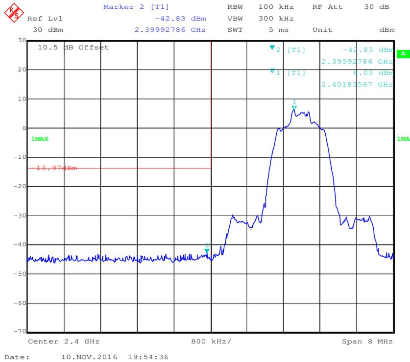
**EDR ( $\pi/4$ -DQPSK): Band Edge-Right Side**
