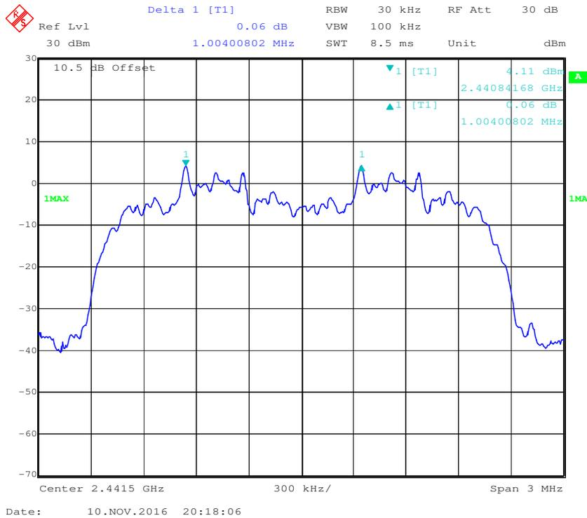
**EDR ( $\pi/4$ -DQPSK): High Channel**
