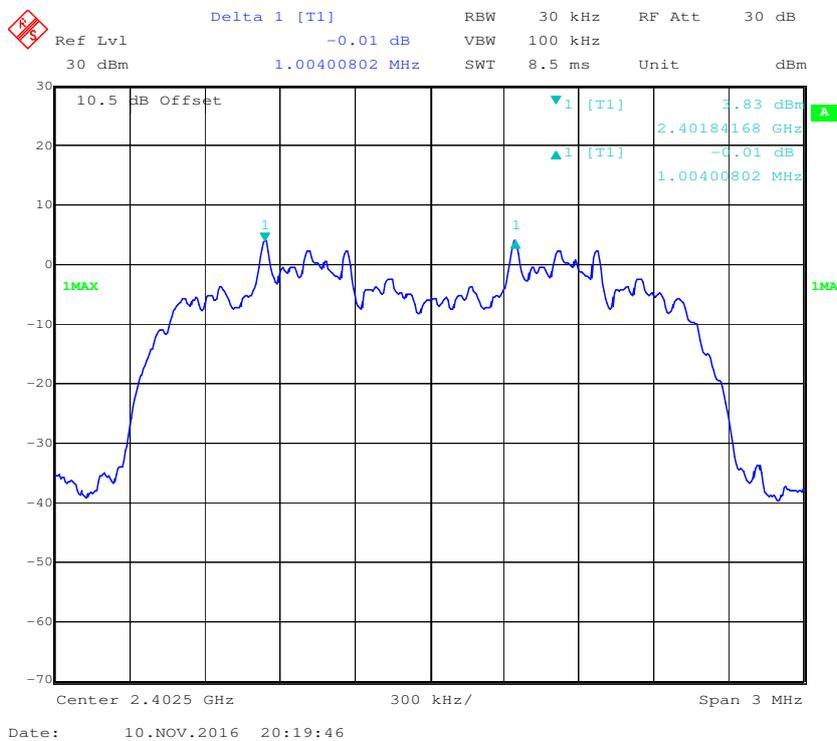
**EDR ( $\pi/4$ -DQPSK): Middle Channel**
