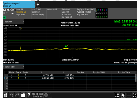
N5(20M)_DFT-s-OFDM QPSK Edge 1RB Left Mid CH
