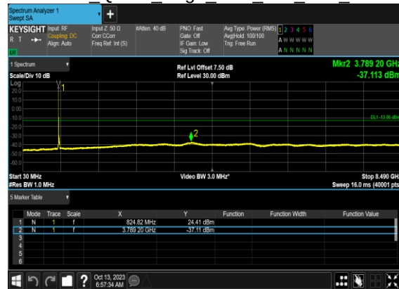
N5(20M)_DFT-s-OFDM QPSK Edge 1RB Left Low CH
