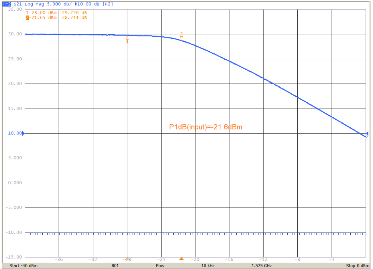
Abbildung 8 GNSS P1dB Kompression
