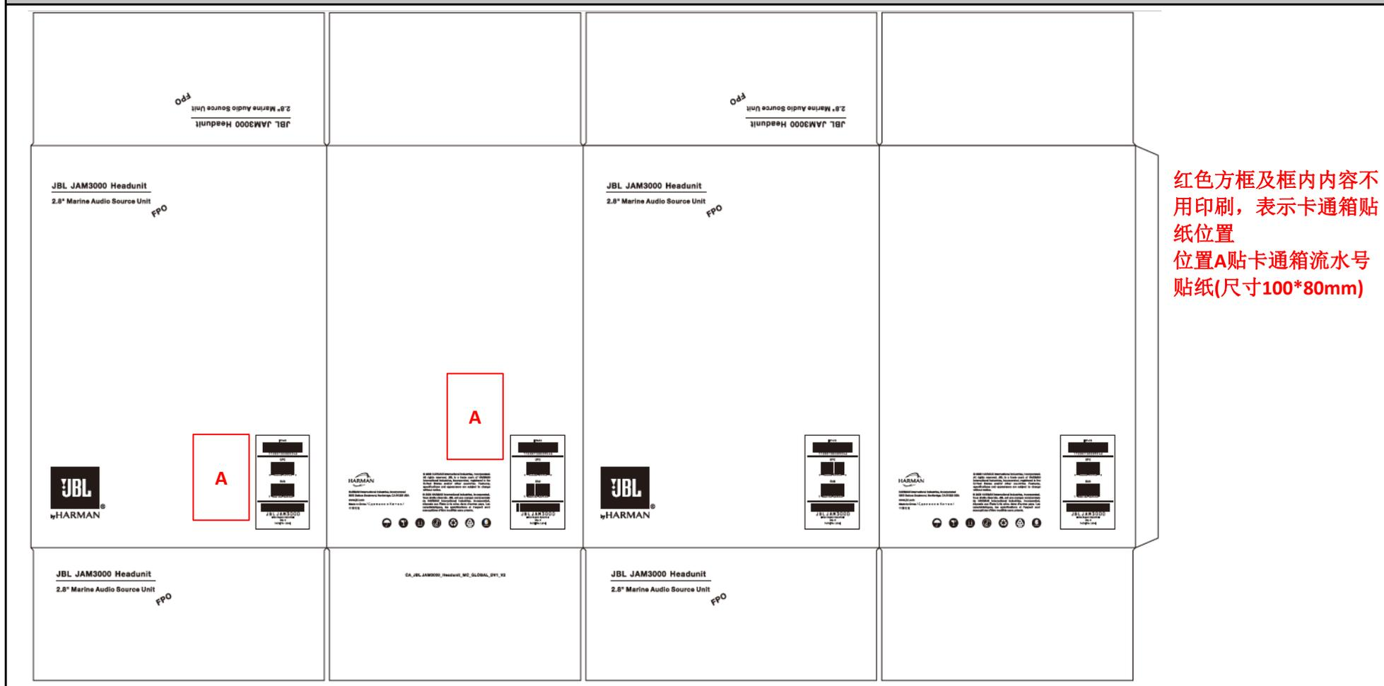
2. 卡通箱流水号贴纸，尺寸100x80mm，白色底黑色字,上面格式为数字矩阵，下面格式为CODE128，请注意流水号前面要有"SN:"字样但条码扫出来不显示"SN:"。卡通箱外面的流水号必须与里面机子上的流水号一致。一个卡通箱上贴2个，贴在相邻的两个面上(参考下图中红色标记位置) Part No.: 57-J3000CTLXA-XXX
