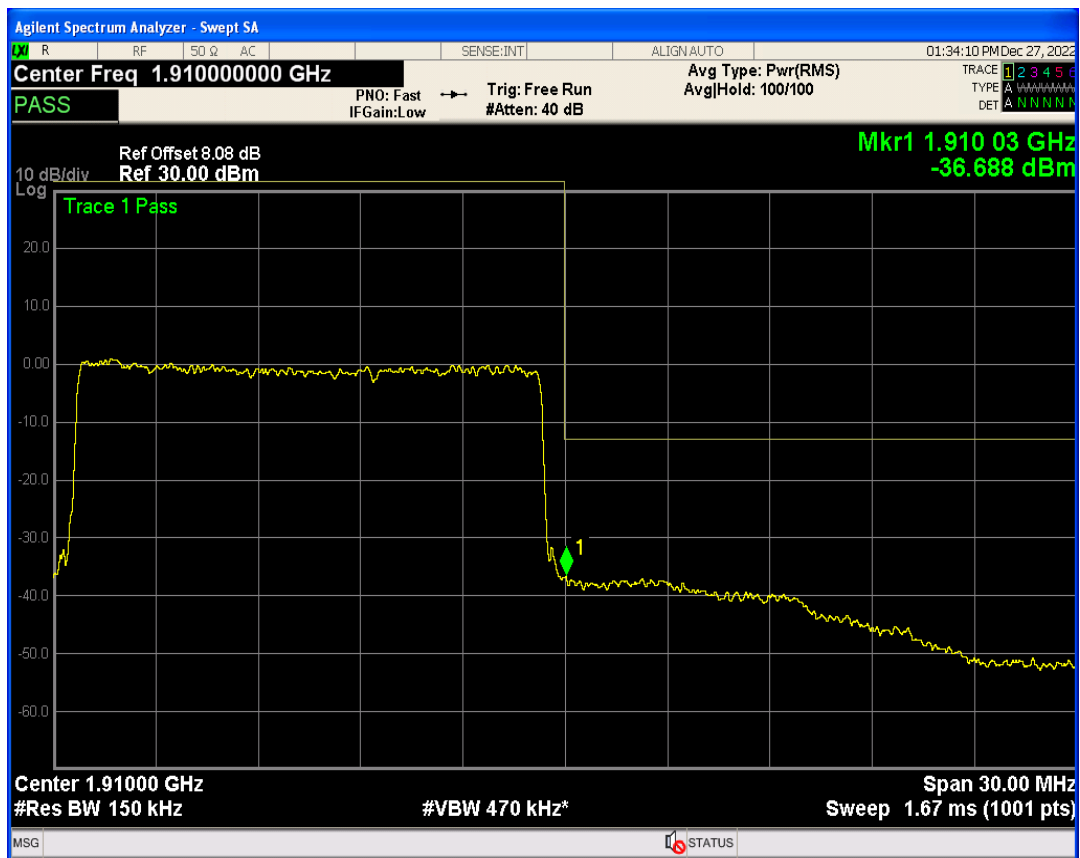
Band2 QPSK BW=20MHz Channel=18700 RB Size=1 Position=#0
