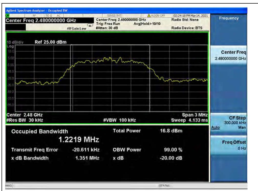
( \pi/4 -DQPSK, Channel 78, 2480MHz)
