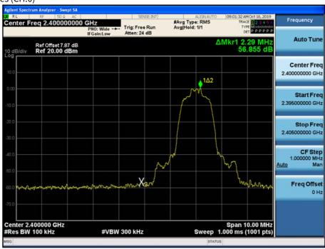
Test Plots without hopping ( $\pi/4DQPSK$ )
