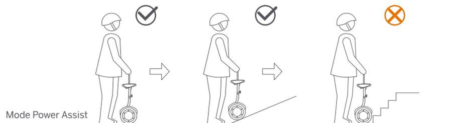
Tirez vers le haut la barre de guidage pour passer en mode Power Assist (allumé, sans conducteur). Orientez le S-Max sur des surfaces lisses à l'aide de la barre de guidage.
