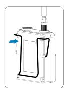
1. 将金属背夹对准发射器两侧的插入孔
