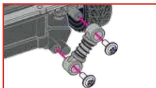
Hold the bar while assembling the springs to the chassis. / Tenez la barre tout en assemblant les ressorts au châssis. / Sostenga la barra mientras ensambla los spings al chasis.
