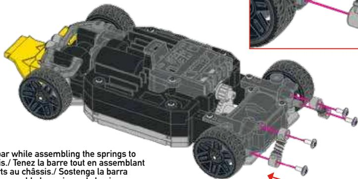
Hold the bar while assembling the springs to the chassis. / Tenez la barre tout en assemblant les ressorts au châssis. / Sostenga la barra mientras ensambla los spings al chasis.
