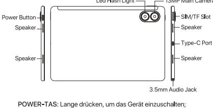
POWER-TAS: Lange drücken, um das Gerät einzuschalten; Wenn das Gerät eingeschaltet ist, drücken Sie kurz die Ein-/Aus-Taste, um den Bildschirm herunterzufahren oder einzuschalten.
