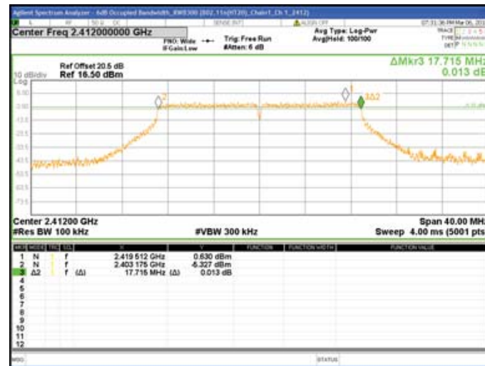
Chain1 : 6dB Bandwidth @ 802.11n(HT20) Mode Ch 6
