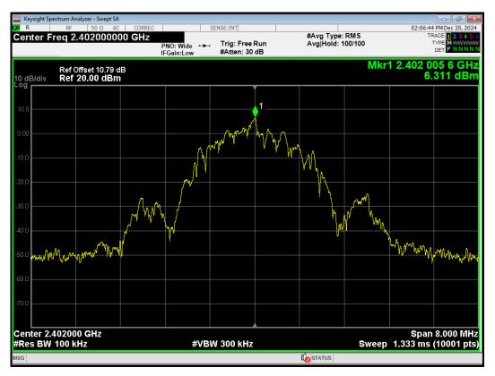
Band Edge nRF 2.4GHz 2402MHz Emission
