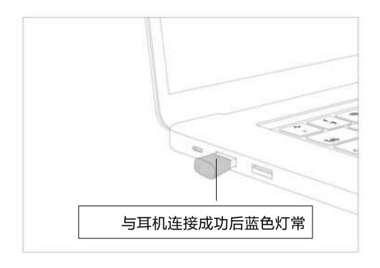
注:当不使用 USB 适配器时,请先把耳机关机再从电脑上拔出适配器。
