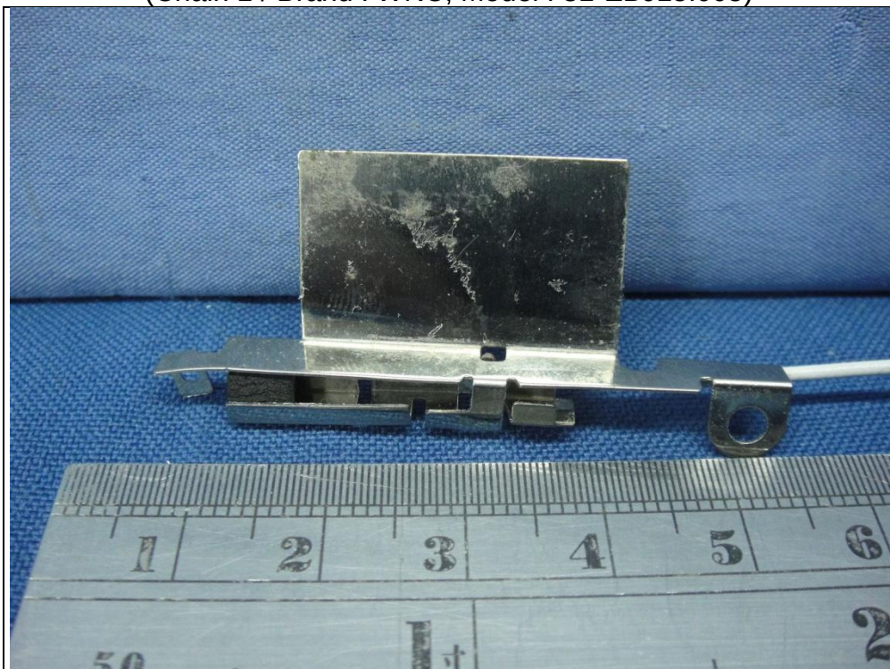
Antenna set 1 (Chain 1 / Brand : WNC, Model : 81-EBJ15.005)
