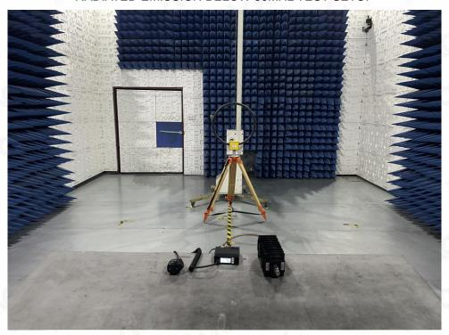
RADIATED EMISSION 30MHz-1GHz TEST SETUP
