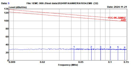
Data no. : 5 Ant. pol. : COPLANAR Site no. : 2# 966 chamber Dis. / Ant. : 3m FMZB 1519B
