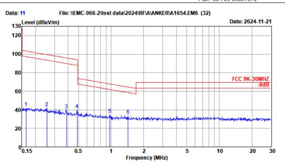
: 2# 966 chamber Site no. Data no. : 11 Dis. / Ant. : 3m FMZB 1519B Ant. pol. : COPLANAR
