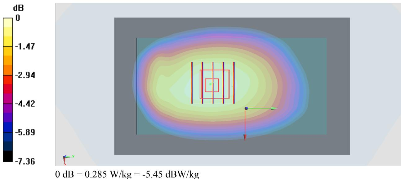
**#34\_LTE Band 5\_10M\_QPSK\_1RB\_0offset\_Back\_10mm\_Ch20600**
