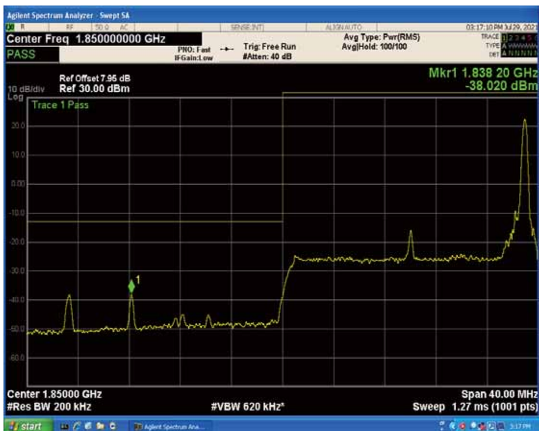
Band2 QPSK BW=20MHz Channel=18700 RB Size=1 Position=#0
