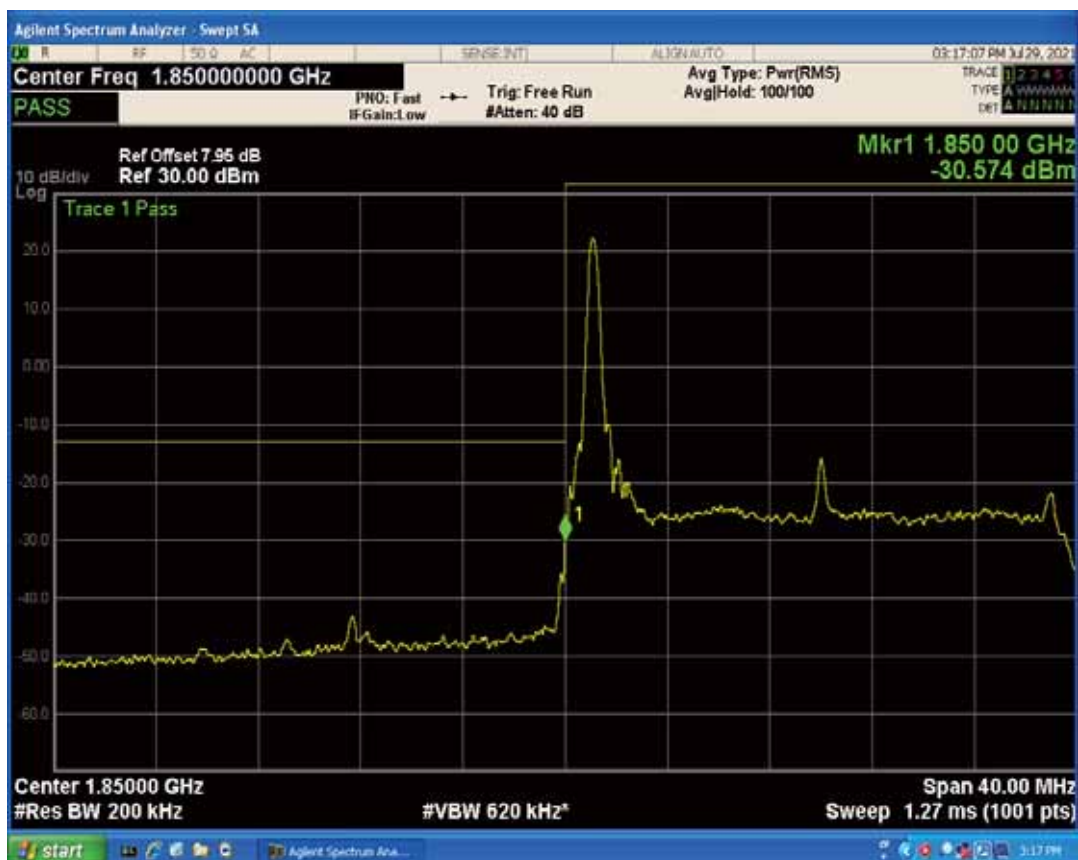
Band2 QPSK BW=20MHz Channel=18700 RB Size=100 Position=#0
