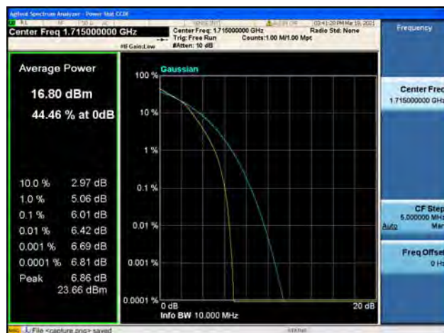
Band4 / 10MHz / Low CH / 16QAM
