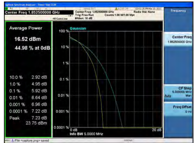
Band2 / 5MHz / Mid CH / QPSK
