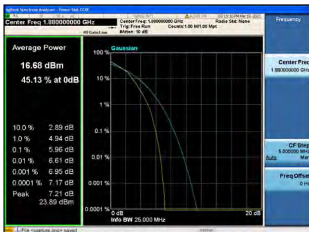
Band2 / 15MHz / Mid CH / 16QAM
