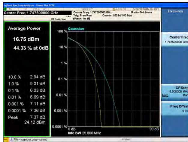
Band4 / 20MHz / Low CH / 16QAM
