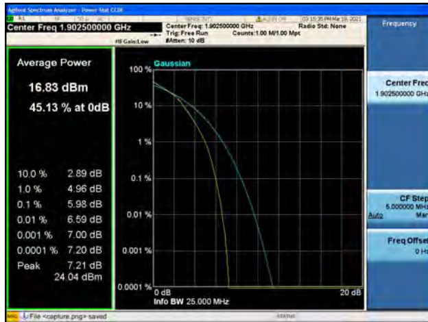
Band2 / 20MHz / Low CH / 16QAM
