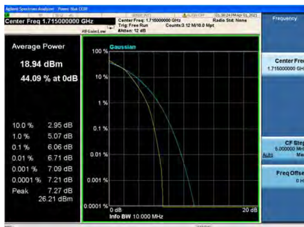
Band66 / 10MHz / Low CH / 16QAM
