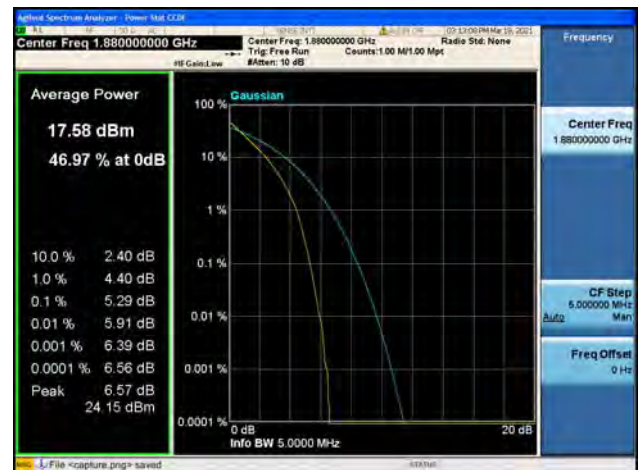
Band2 / 5MHz / Mid CH / 64QAM
