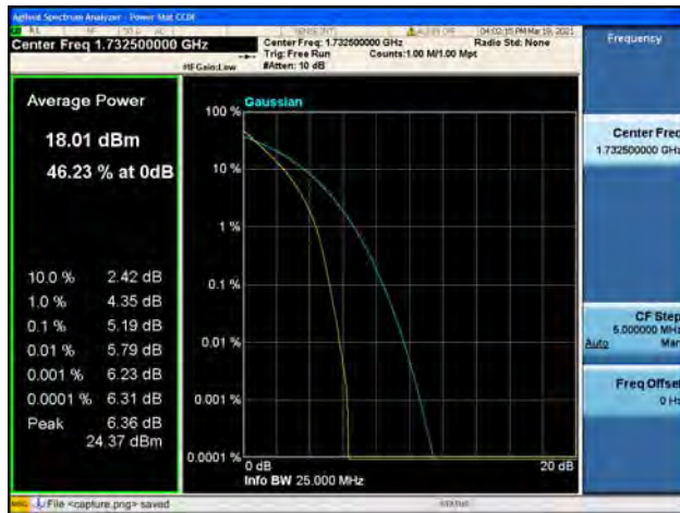
Band4 / 20MHz / Mid CH / 64QAM
