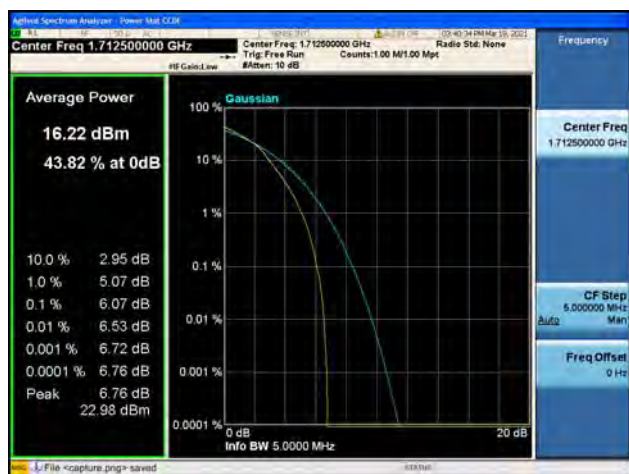
Band4 / 5MHz / Mid CH / QPSK
