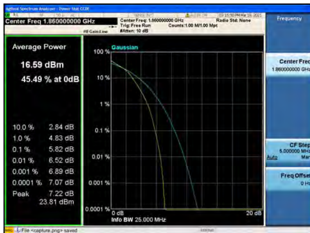
Band2 / 20MHz / Low CH / 16QAM
