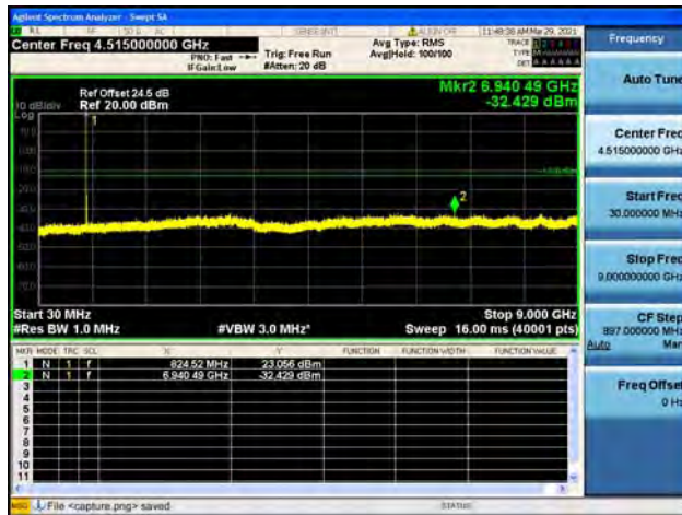
Band5 / 5MHz / Low CH / 64QAM
