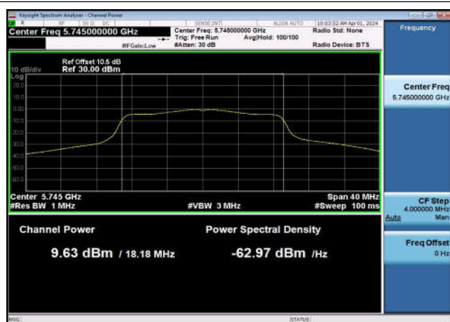
U-NII-3 Output Power-802.11ac(20MHz) ,5745MHz,Ant1
