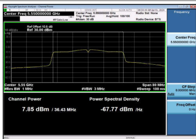
U-NII-2c Output Power-802.11ac(40MHz) ,5550MHz,Ant1
