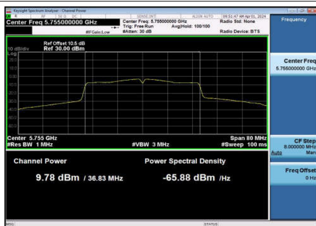
U-NII-3 Output Power-802.11n(40MHz) ,5755MHz,Ant1
