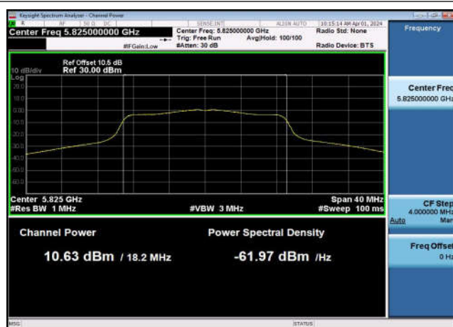
U-NII-3 Output Power-802.11ac(40MHz) ,5795MHz,Ant1
