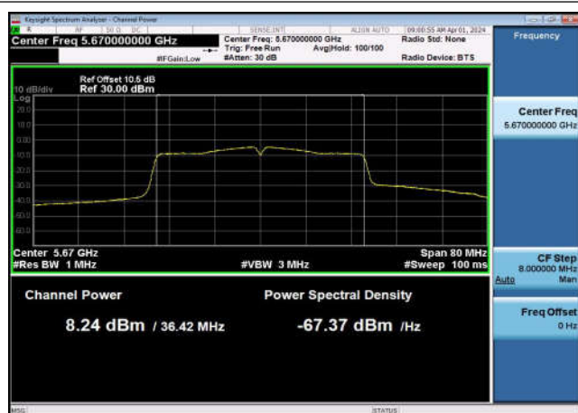
U-NII-3 Output Power-802.11n(20MHz) ,5745MHz,Ant1
