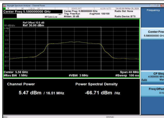
U-NII-2c Output Power-802.11n(20MHz) ,5580MHz,Ant1
