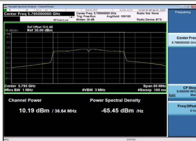
U-NII-3 Output Power-802.11ac(40MHz) ,5795MHz,Ant1
