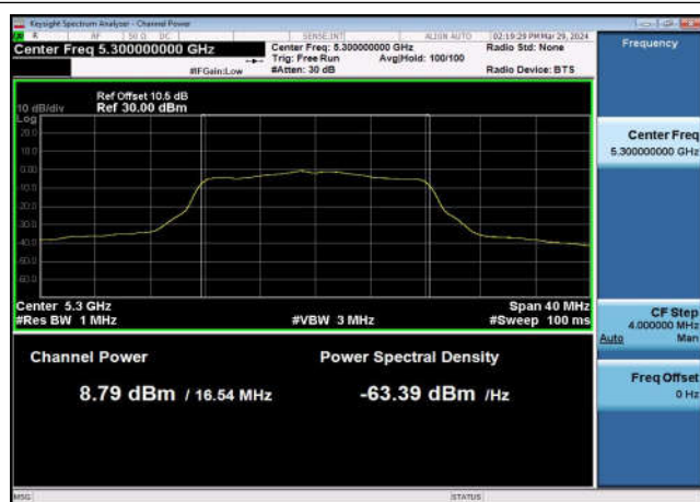
U-NII-2a Output Power-802.11ac(20MHz) ,5260MHz,Ant1
