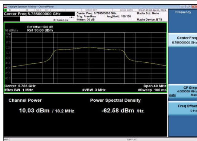
U-NII-3 Output Power-802.11n(40MHz) ,5755MHz,Ant1
