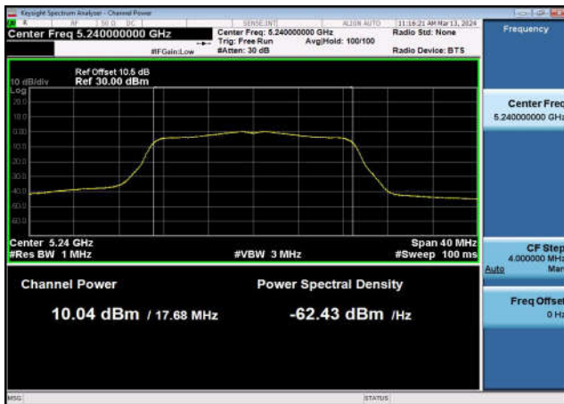
U-NII-1 Output Power-802.11n(40MHz) ,5230MHz,Ant1
