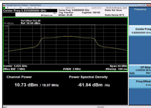
U-NII-3 Output Power-802.11n(20MHz) ,5825MHz,Ant1
