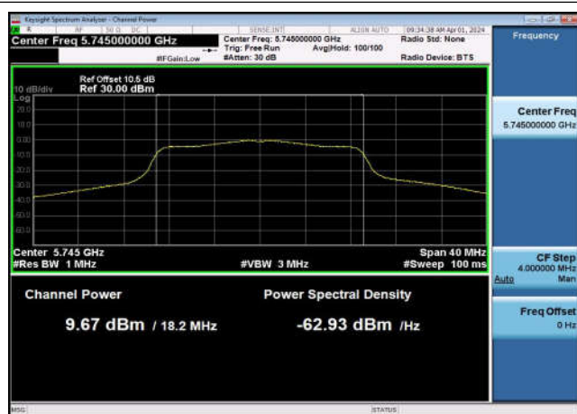
U-NII-3 Output Power-802.11n(20MHz) ,5825MHz,Ant1
