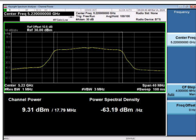
U-NII-1 Output Power-802.11ac(40MHz) ,5190MHz,Ant1
