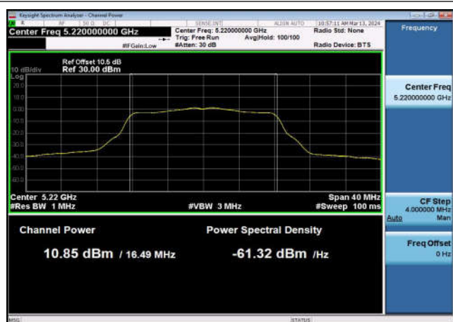
U-NII-1 Output Power-802.11ac(20MHz) ,5180MHz,Ant1
