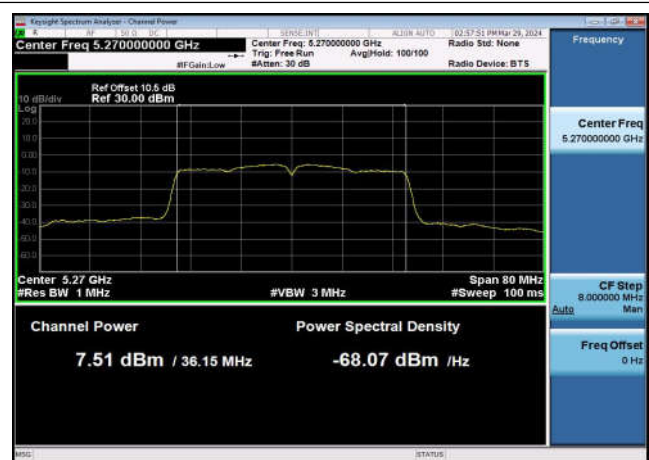
U-NII-2a Output Power-802.11n(40MHz) ,5270MHz,Ant1
