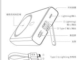
①②均是双向快充接口,建议使用机乐堂专用自带线,自带线lightning头 ①插入设备的①接口位置, Type-C头②插入设备的②接口位置
