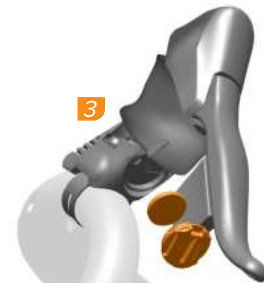
Rabattez le couvre-cocotte vers l'avant puis, à l'aide d'une pièce de monnaie ou de vos doigts, tournez le couvercle de la pile dans le sens inverse des aiguilles d'une montre jusqu'à ce qu'il se bloque. Retirez le couvercle de la pile ainsi que la pile.
