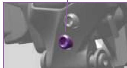
**如果难以将链条从大链环变速至小链环上：**请将前变速器置于内侧位置，同时将低限位螺钉逆时针转动1/8圈，然后再评估。请重复此步骤，直至链条可顺畅地从大链环变速至小链环上。
