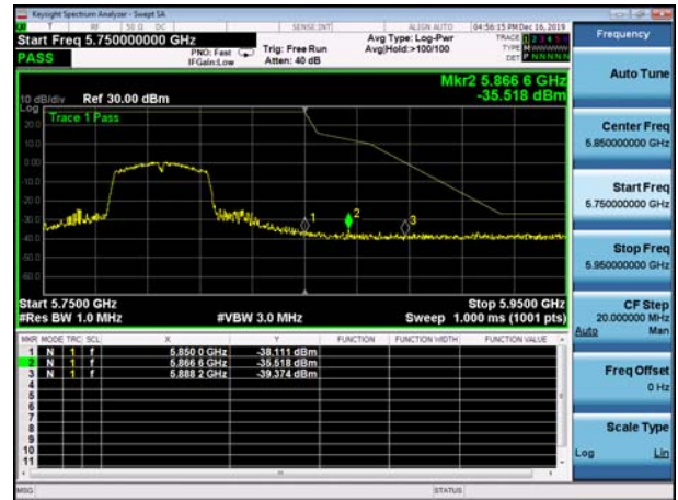
U-NII-3 ,Plot 2,30MHz~5000MHz-802.11n (40MHz),5795MHz,Ant1
