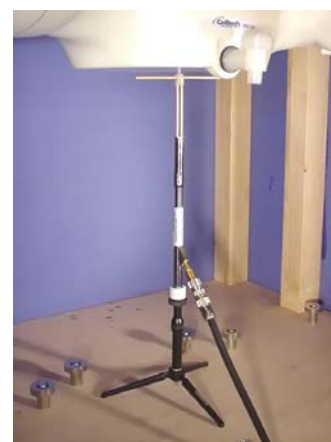
900MHz Dipole Setup
