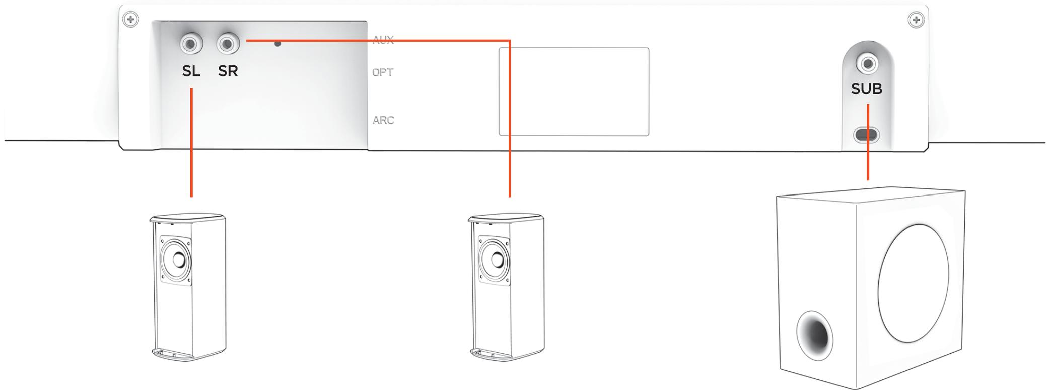
1. Connectez l'extrémité libre du câble de votre enceinte satellite au port de sortie gauche de l'enceinte satellite (SL) sur la barre de son.
