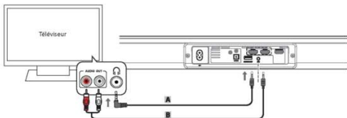
**B** Utilisez un câble audio RCA à 3,5 mm (non inclus) pour brancher les prises de sortie audio du téléviseur à la prise **AUX** située sur l'unité
