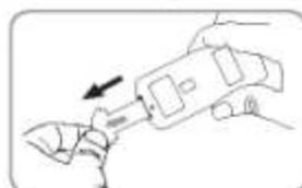
L'unité est dotée d'une pile préinstallée CR2025. Retirez la languette de protection pour activer la pile de la télécommande.
