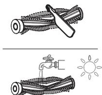
Con la herramienta de limpieza, elimine el pelo y los residuos que hayan quedado enrollados en el rodillo y enjuáguelo con agua. Deje que se seque completamente antes de volver a instalarlo.
