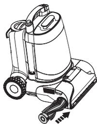
Para volver a colocar el cepillo de rodillo, inserte el extremo del cepillo de rodillo en el lado derecho del soporte y, a continuación, acople la pestaña del rodillo al lado izquierdo para bloquearlo.
