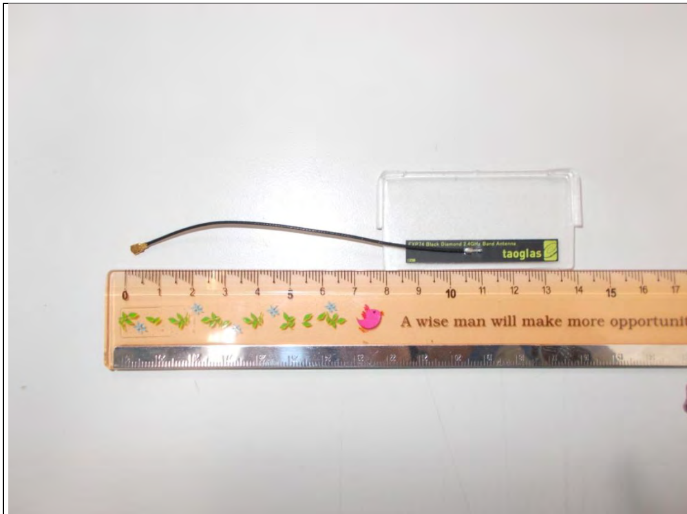
Antenna 4 (Brand: TAOGLAS ; Model: FXP74.07.0100A)
