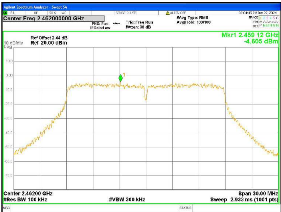
Band Edge NVNT n20 2462MHz Ant1 Ref
