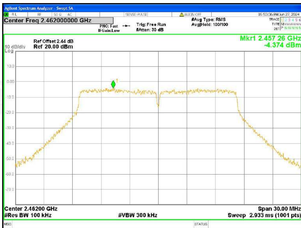
Band Edge NVNT g 2462MHz Ant1 Ref
