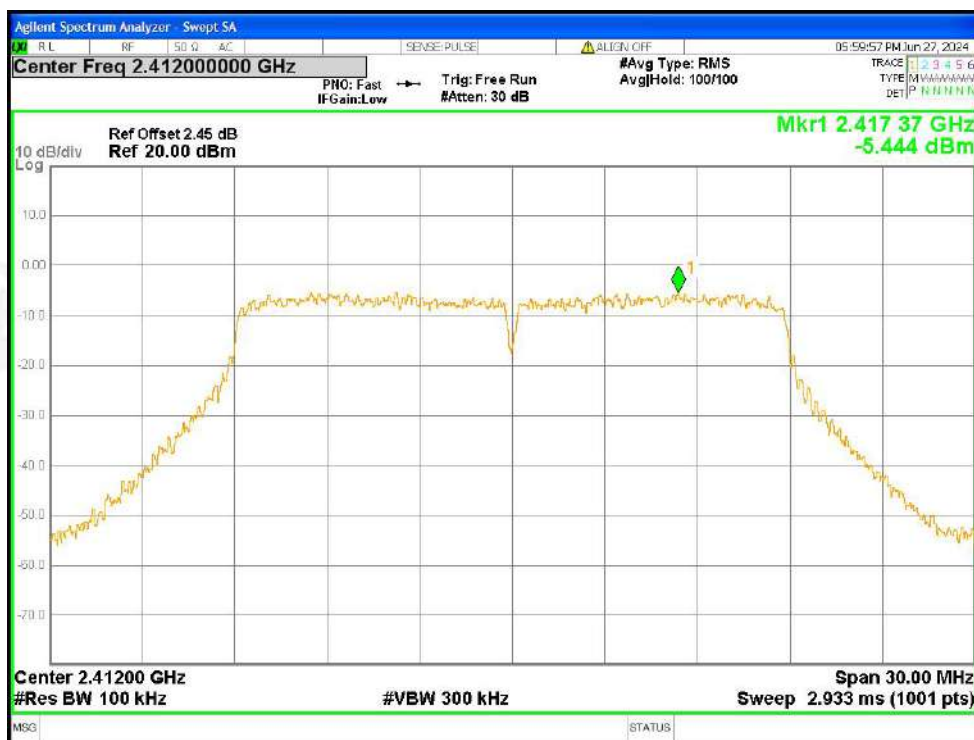
Band Edge NVNT n20 2412MHz Ant1 Ref
