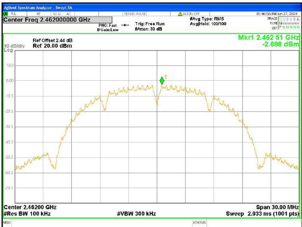
Band Edge NVNT b 2462MHz Ant1 Ref
