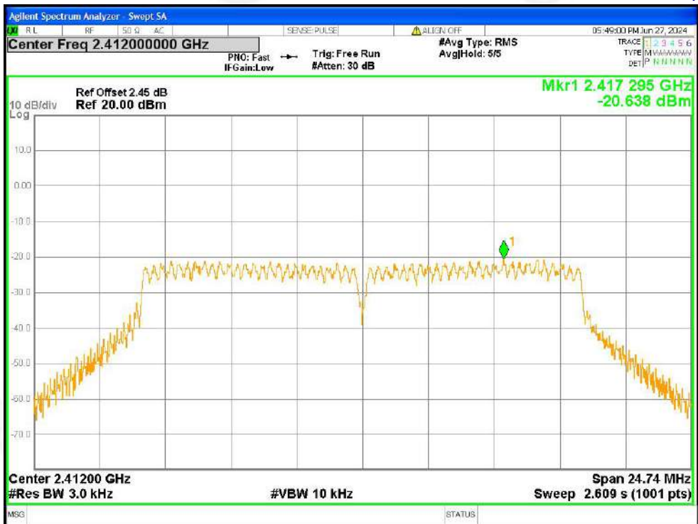
PSD NVNT g 2412MHz Ant1
