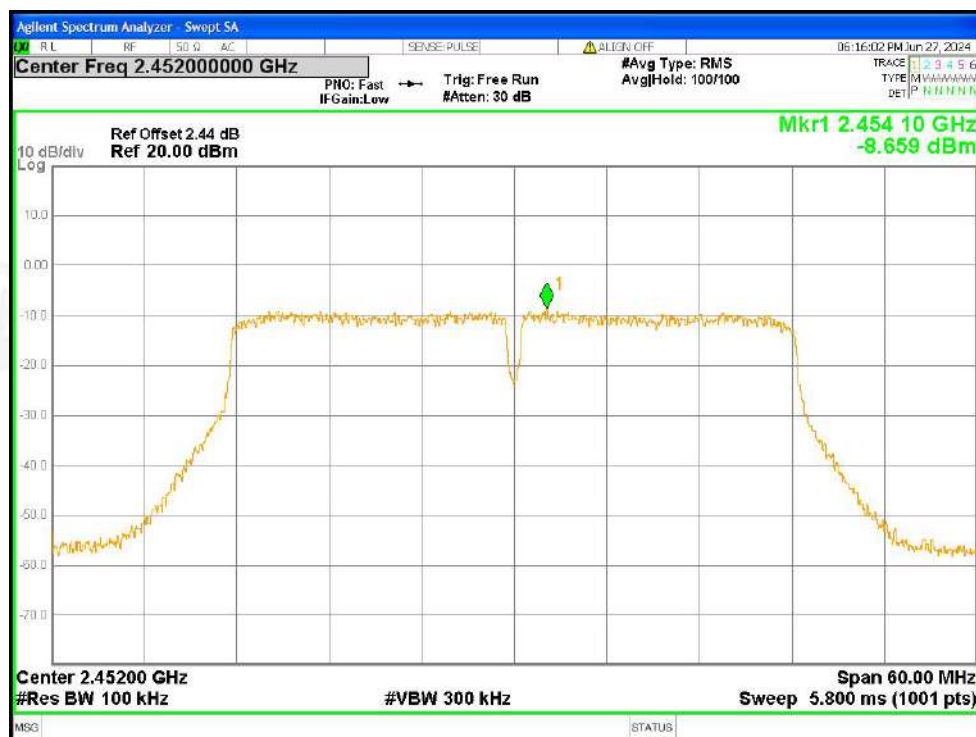
Band Edge NVNT n40 2452MHz Ant1 Ref
