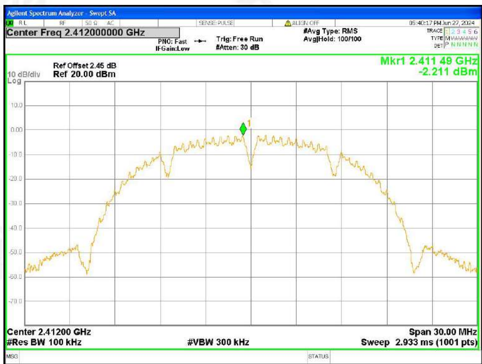
Band Edge NVNT b 2412MHz Ant1 Ref
