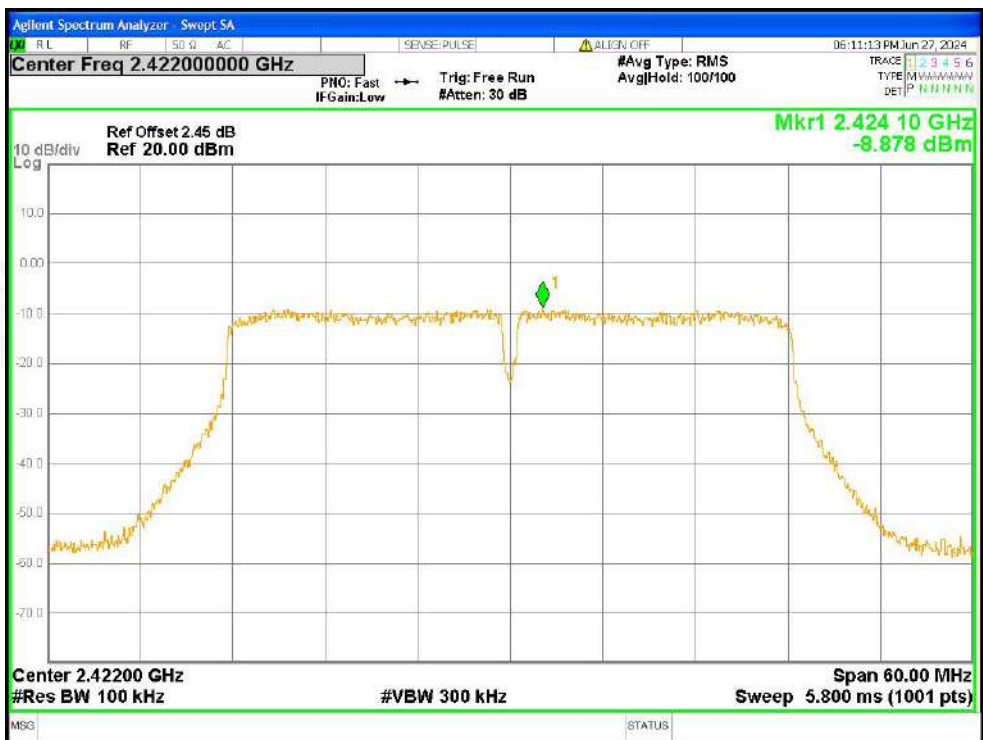
Band Edge NVNT n40 2422MHz Ant1 Ref
