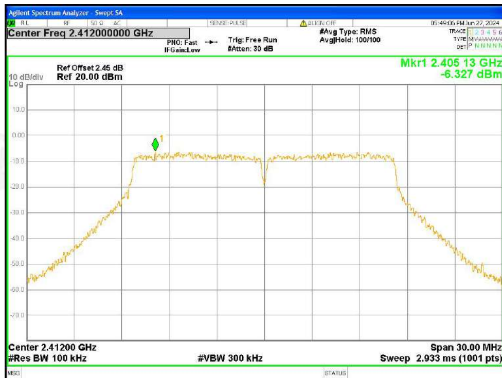
Band Edge NVNT g 2412MHz Ant1 Ref
