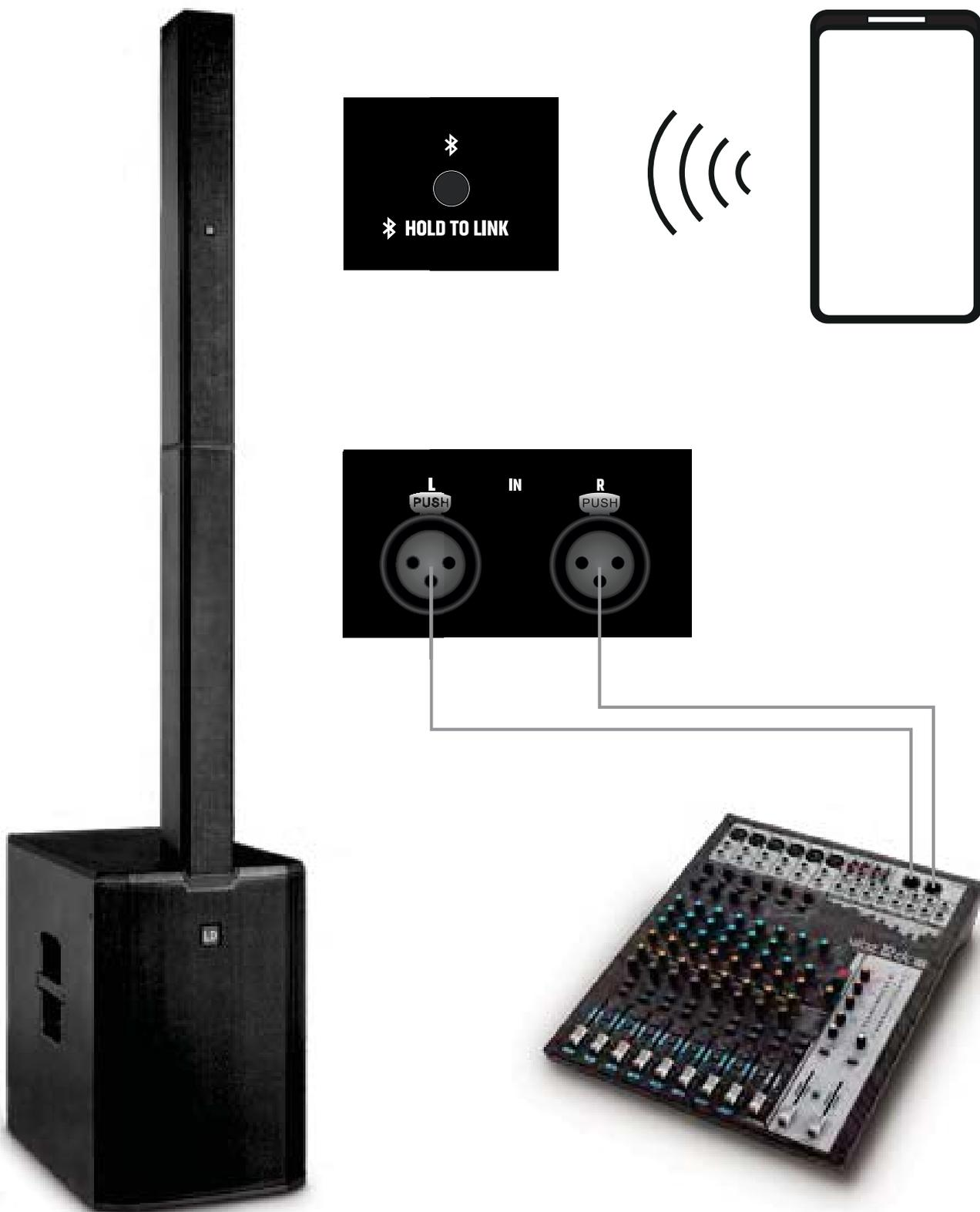
Esempio di modalità di funzionamento stereo
