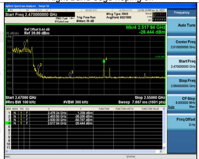
Right Band edge hopping on
