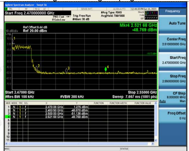
Right Band edge hopping on
