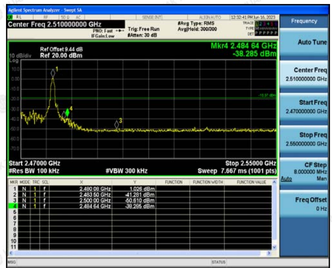
Right Band edge hopping off
