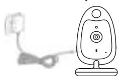
1. Verbinden Sie den kleinen Stecker des Netzteils mit der Babyeinheit und das andere Ende mit der Steckdose.
