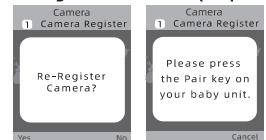
Pulse la tecla "Menú/OK" para acceder a la pantalla de registro de entrada. Pulse de nuevo la tecla "Menú/OK" para que aparezca el mensaje "¿Registrar la cámara?", y pulse la tecla de emparejamiento de la parte posterior de la unidad del bebé antes de que transcurran 10 segundos.
