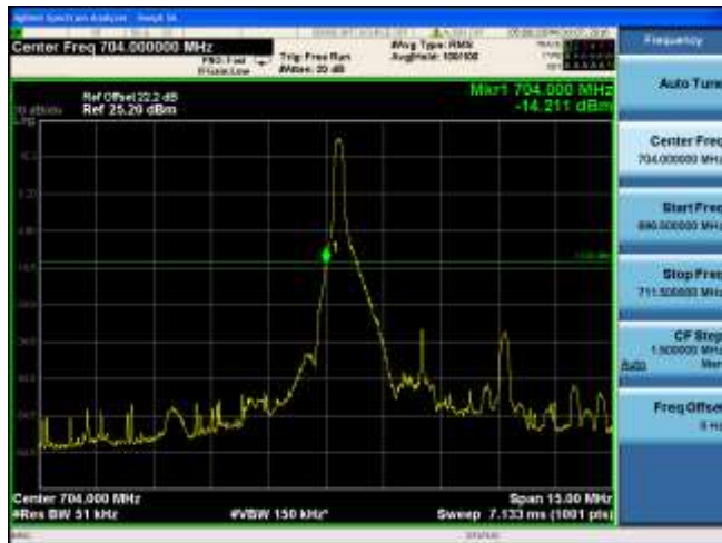
CH23780 (709MHz) QPSK Bandwidth 10MHz 1RB#0
