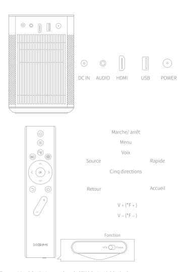
$^* Le \ commutateur \ de \ fonction \ tourne \ vers \ la \ gauche \ (VOL), \ le \ bouton \ +/- \ règlent \ le \ volume \ ; \\ ^* Le \ commutateur \ de \ fonction \ tourne \ vers \ la \ droite \ (Focus), \ le \ bouton \ +/- \ règlent \ le \ focus.$
