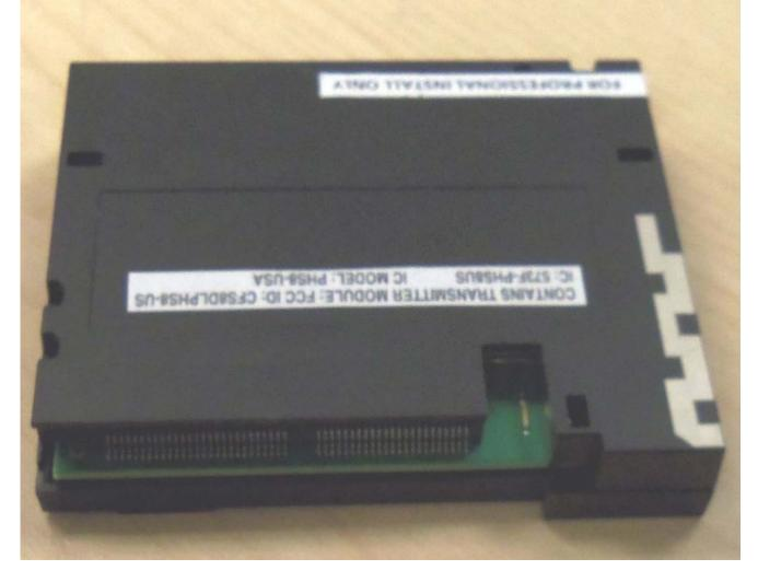
PLASTIC CASE EDGE SHOWING 100 PIN CONNECTOR, PHOTO 2
