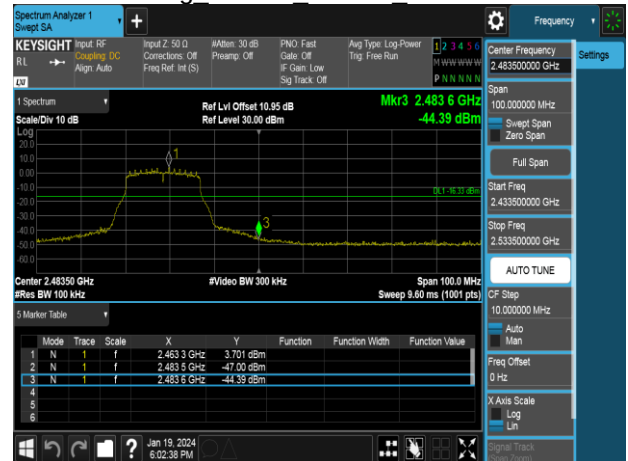
802.11n 20MHz Chain0 2412MHz
