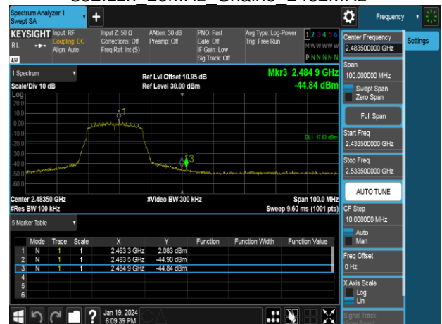
802.11n 20MHz Chain0 2462MHz
