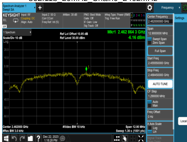
802.11b 20MHz Chain0 2462MHz
