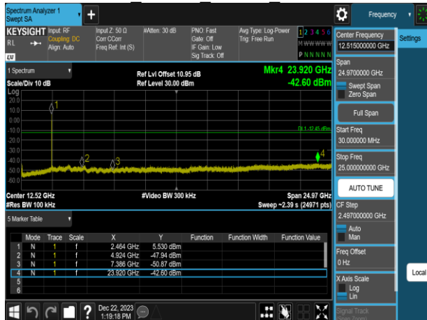
802.11b 20MHz Chain0 2462MHz
