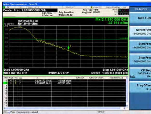
Band2 / 15MHz / High CH / QPSK / 1 RB
