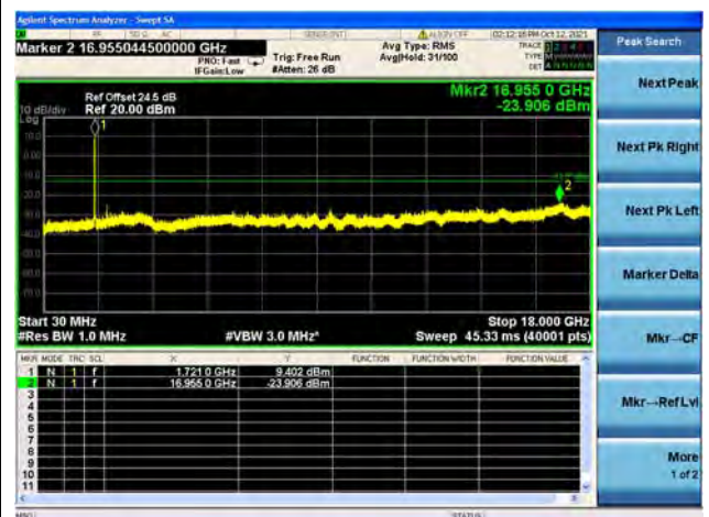
Band66 / 20MHz / Low CH / 64QAM
