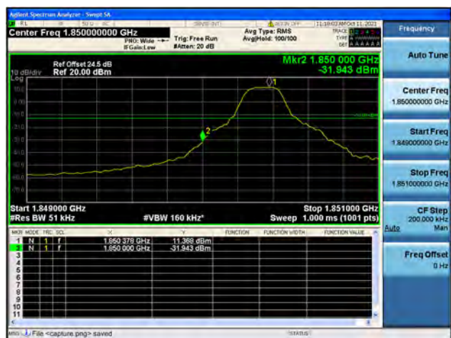
Band2 / 5MHz / High CH / QPSK / 1 RB
