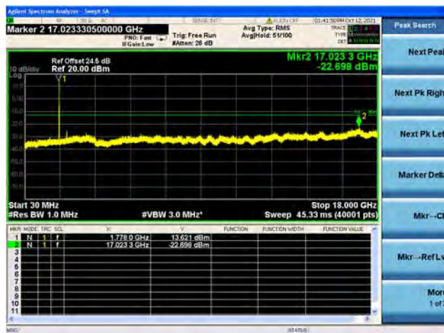
Band66 / 10MHz / Low CH / 16QAM
