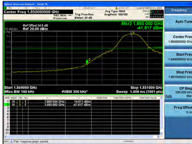
Band2 / 10MHz / High CH / QPSK / 1 RB
