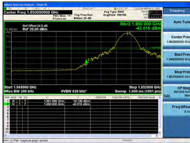
Band2 / 20MHz / High CH / QPSK / 1 RB
