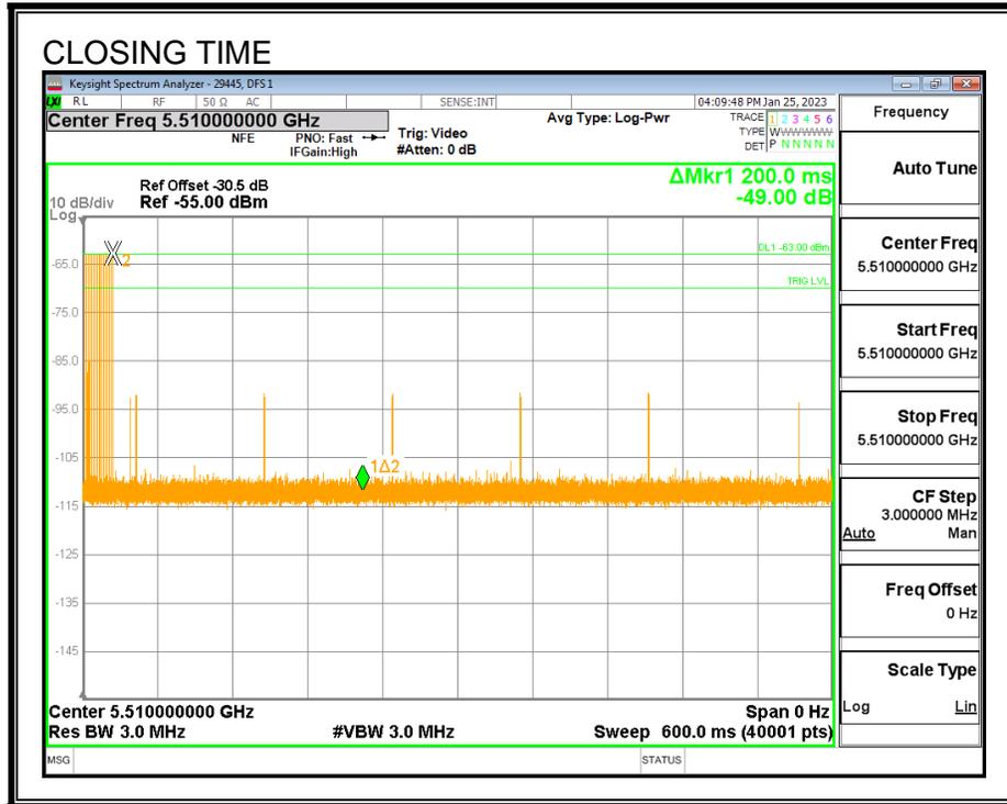
**AGGREGATE CHANNEL CLOSING TRANSMISSION TIME**
