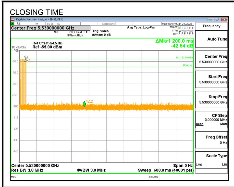
**AGGREGATE CHANNEL CLOSING TRANSMISSION TIME**
