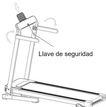
Paso 4. Insértelo en el enchufe del tubo del marco de acuerdo con la dirección, enchúfelo firmemente, inserte el otro extremo en el enchufe de 120 V y gire el interruptor de encendido a la posición del símbolo "—". Después de que la luz esté encendida, puede comenzar a usar el producto.
