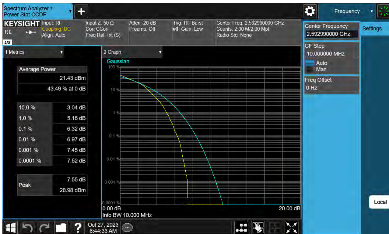
Sub6 n41. PAR Plot (10 M BW_Ch.518598_16QAM)
