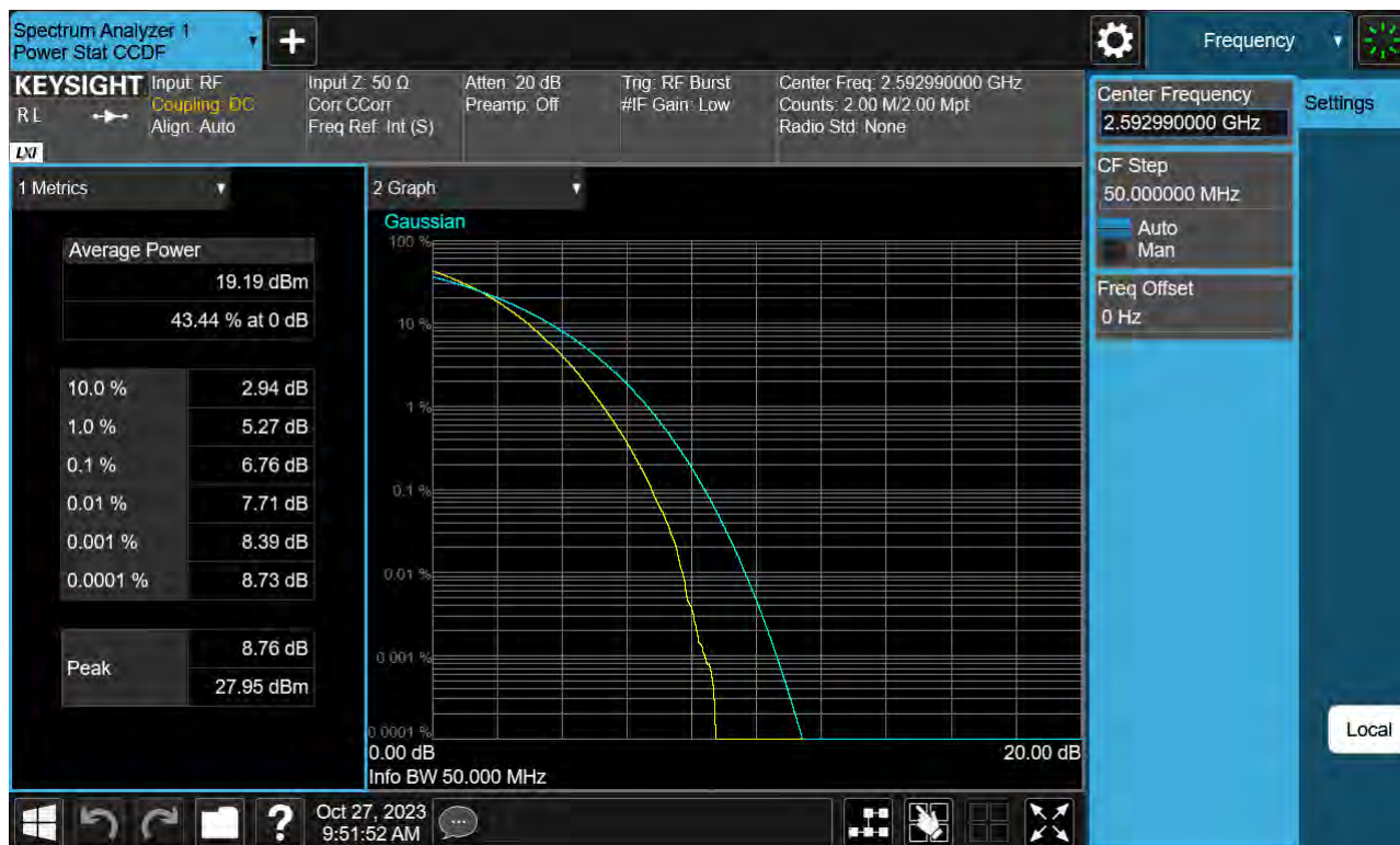
Sub6 n41. PAR Plot (50 M BW_Ch.518598_256QAM)
