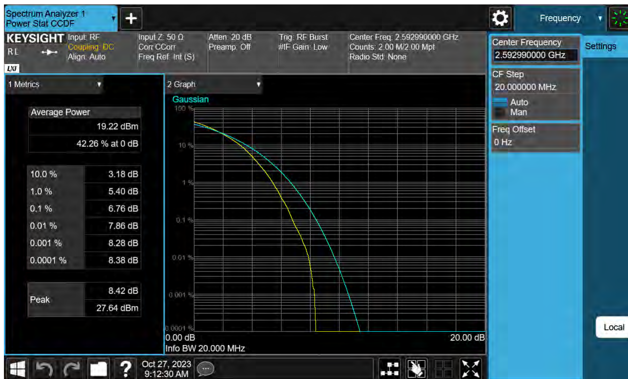
Sub6 n41. PAR Plot (20 M BW_Ch.518598_256QAM)
