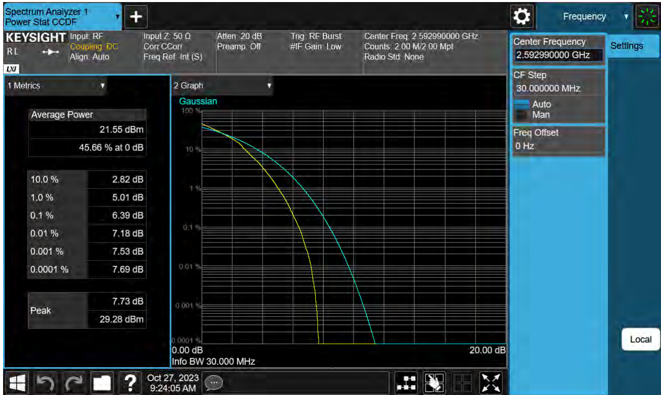
Sub6 n41. PAR Plot (30 M BW_Ch.518598_16QAM)
