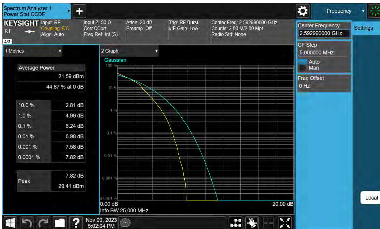
Sub6 n41. PAR Plot (25 M BW_Ch.518598_16QAM)
