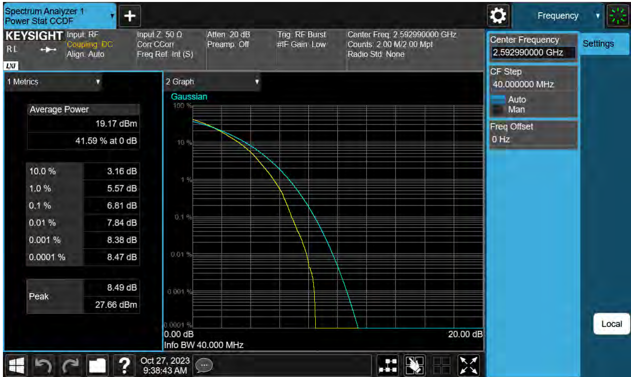
Sub6 n41. PAR Plot (40 M BW_Ch.518598_256QAM)
