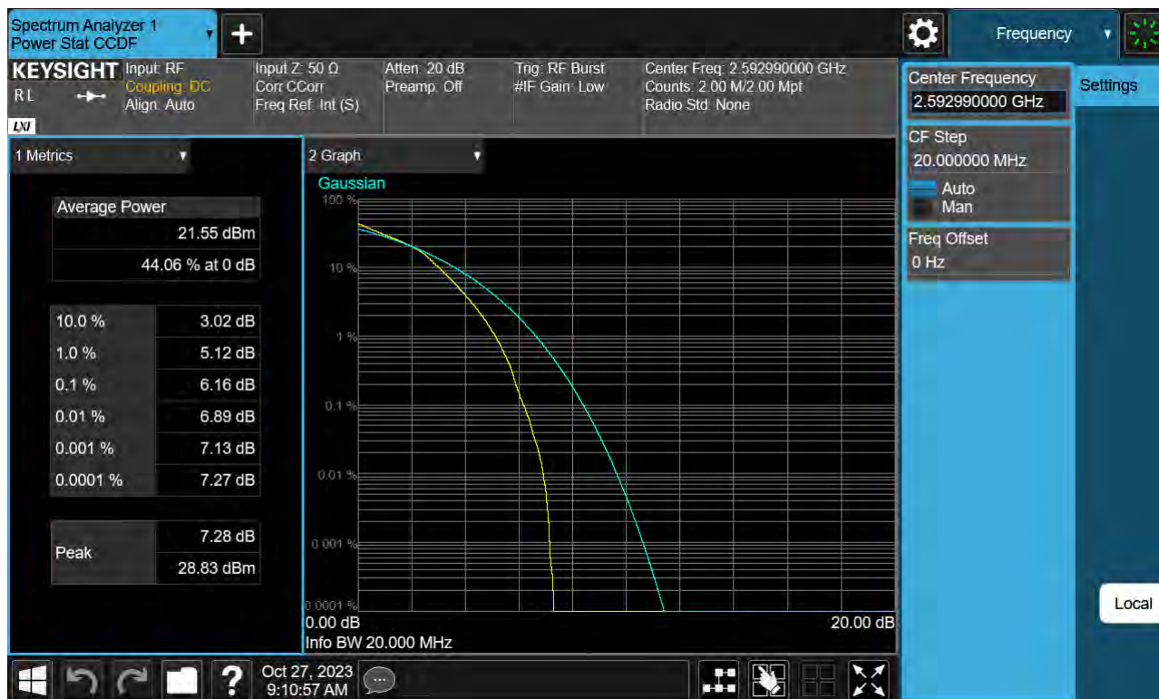
Sub6 n41. PAR Plot (20 M BW_Ch.518598_16QAM)
