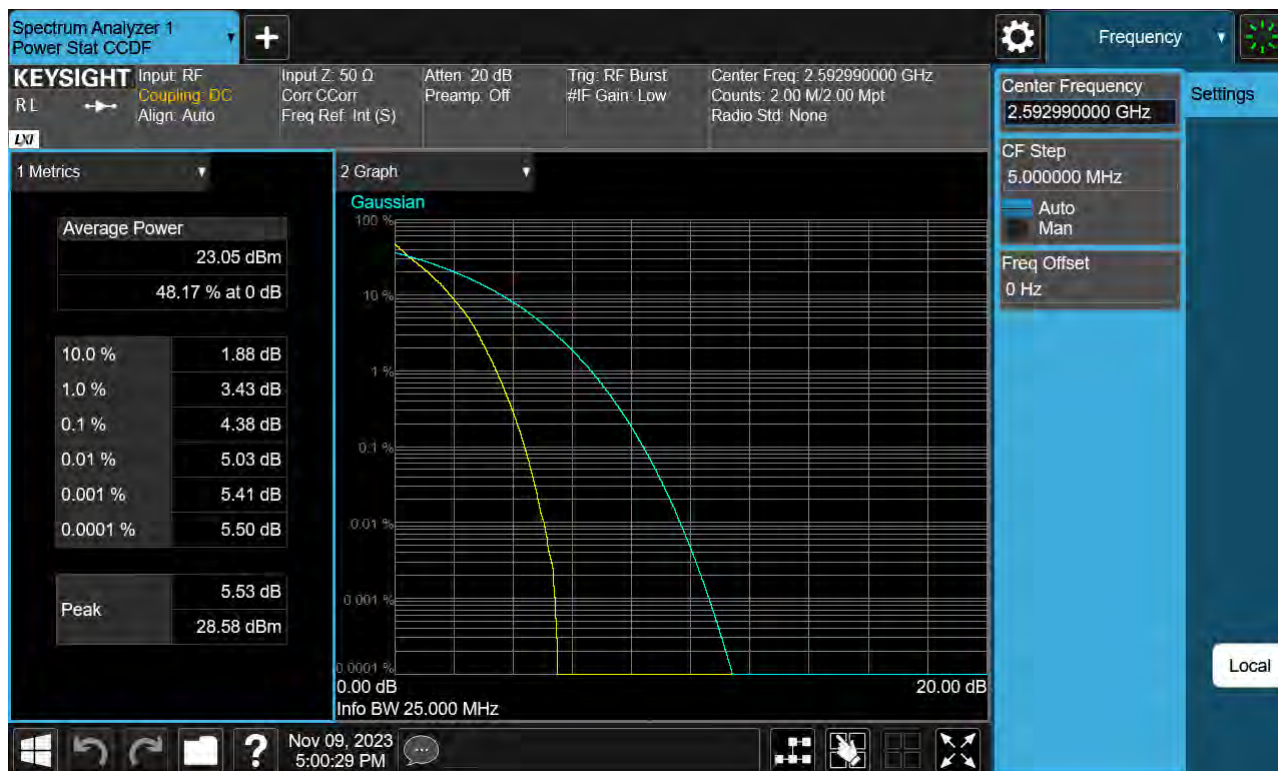
Sub6 n41. PAR Plot (25 M BW_Ch.518598_BPSK)
