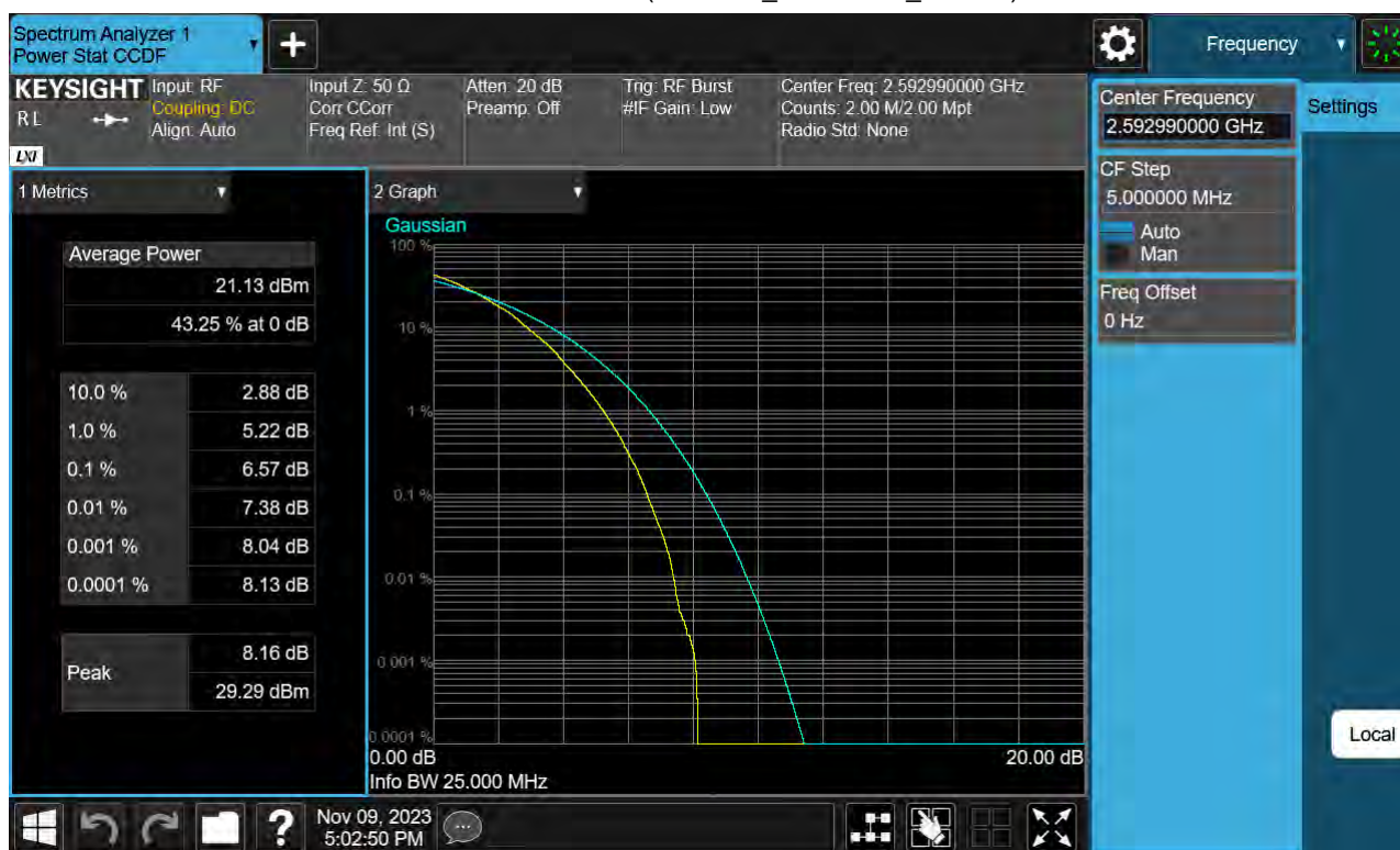
Sub6 n41. PAR Plot (25 M BW_Ch.518598_64QAM)
