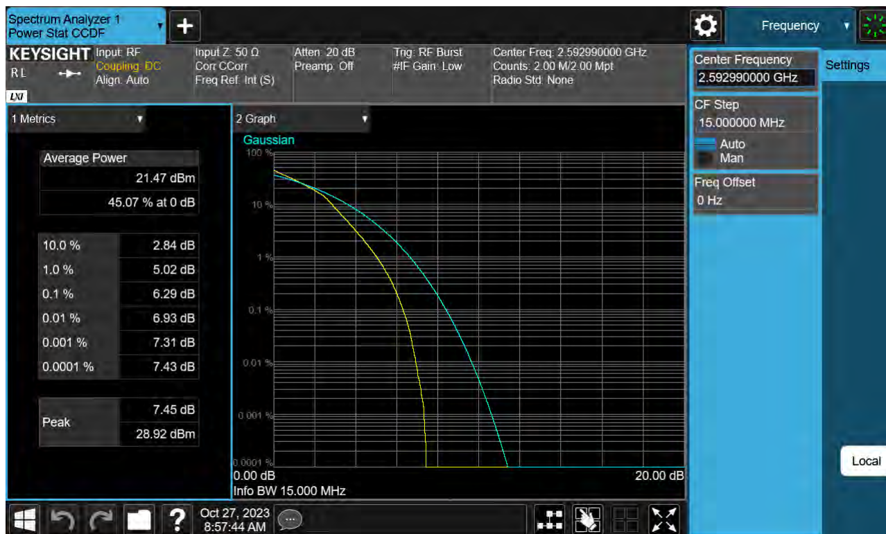
Sub6 n41. PAR Plot (15 M BW_Ch.518598_16QAM)
