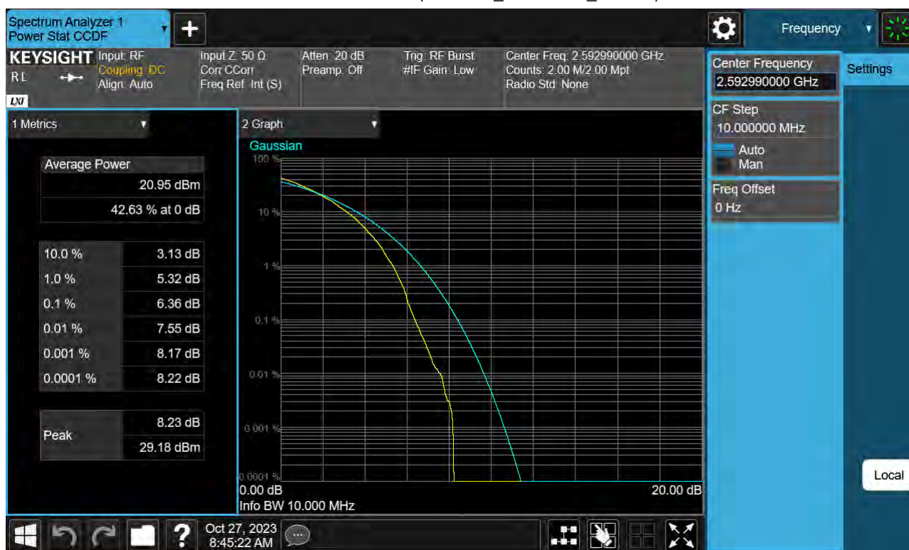
Sub6 n41. PAR Plot (10 M BW_Ch.518598_64QAM)
