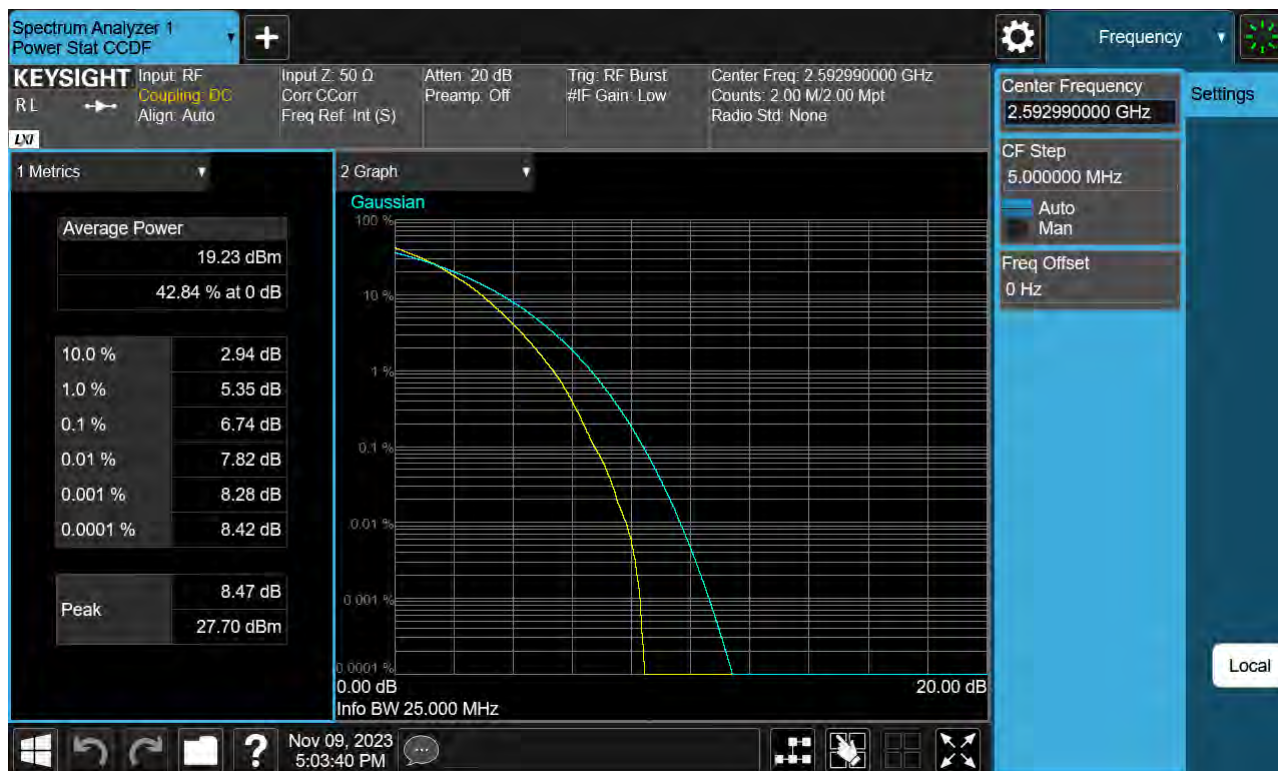
Sub6 n41. PAR Plot (25 M BW_Ch.518598_256QAM)
