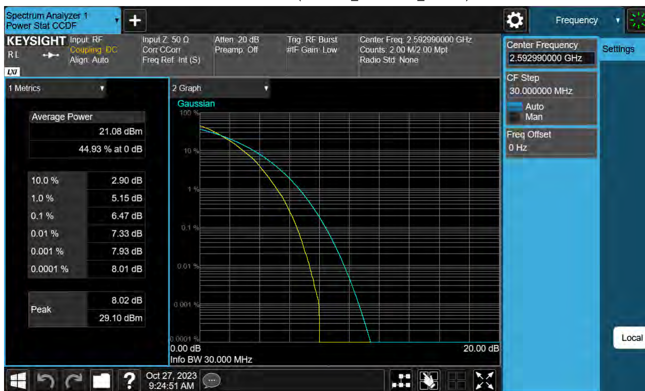
Sub6 n41. PAR Plot (30 M BW_Ch.518598_64QAM)
