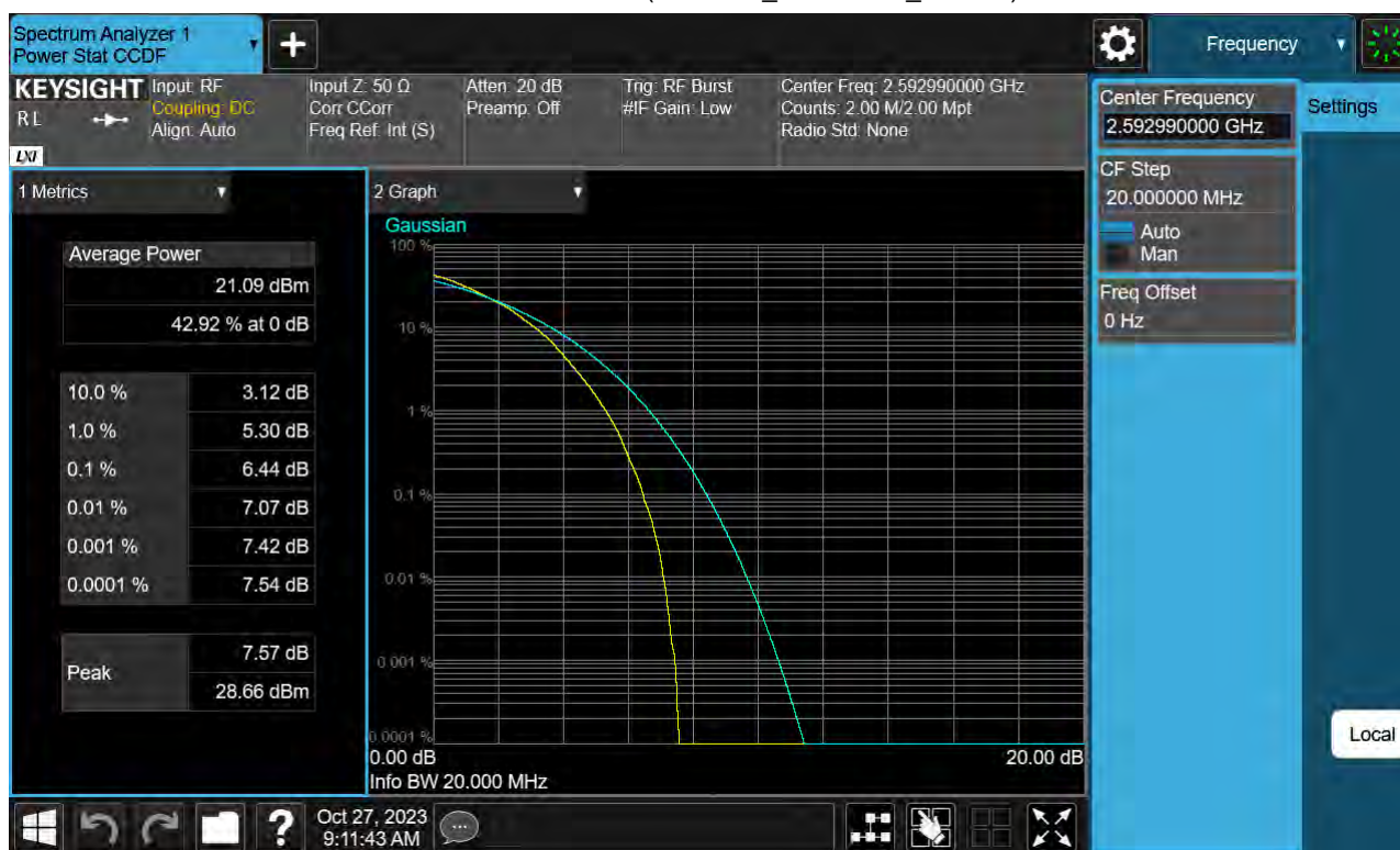
Sub6 n41. PAR Plot (20 M BW_Ch.518598_64QAM)
