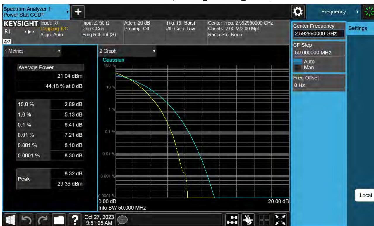
Sub6 n41. PAR Plot (50 M BW_Ch.518598_64QAM)
