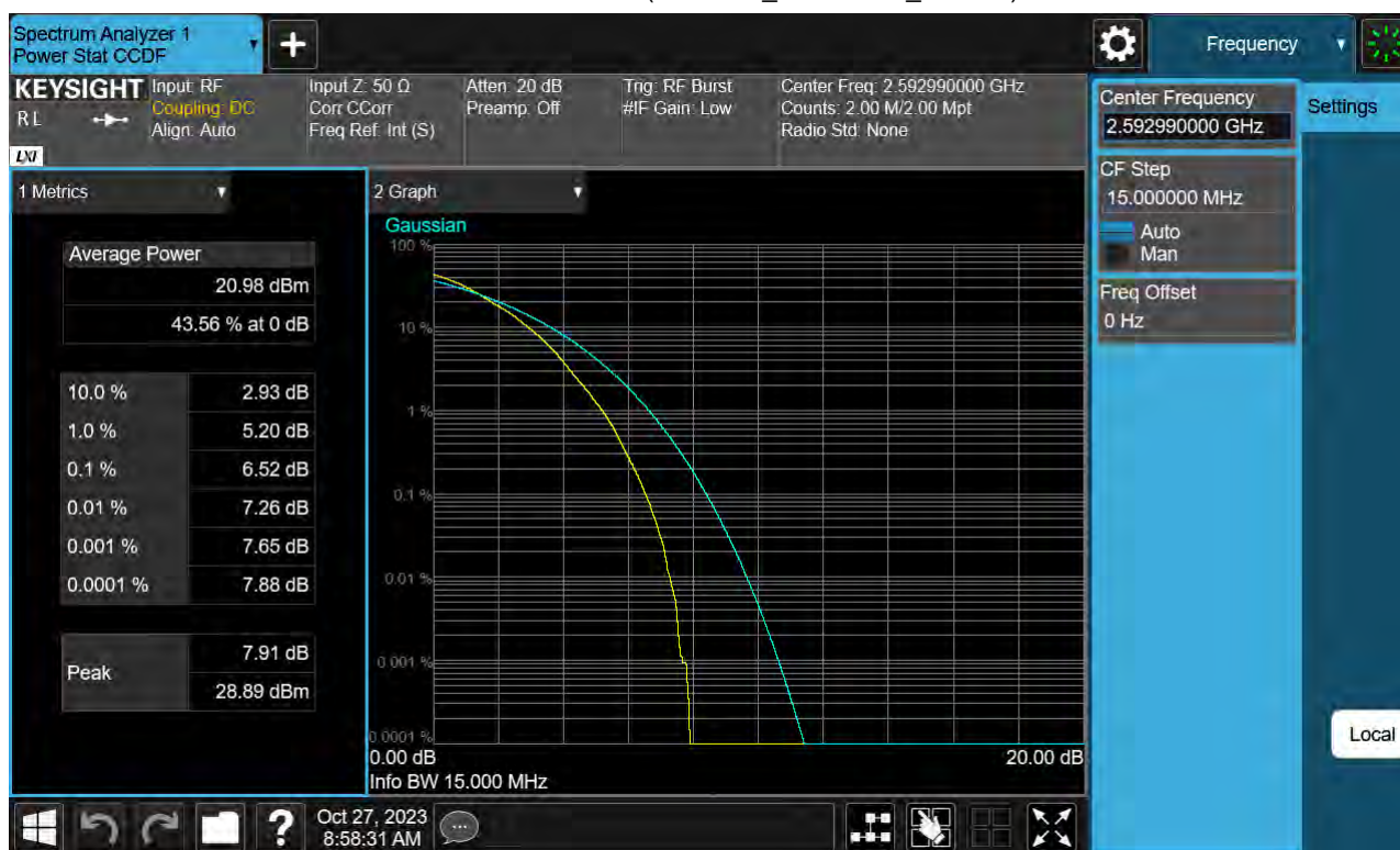
Sub6 n41. PAR Plot (15 M BW_Ch.518598_64QAM)
