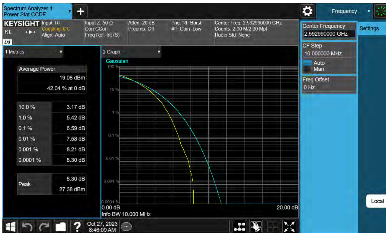
Sub6 n41. PAR Plot (10 M BW_Ch.518598_256QAM)
