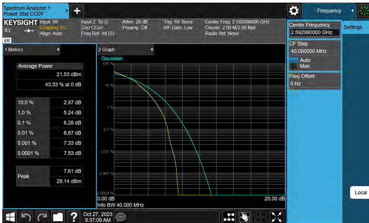
Sub6 n41. PAR Plot (40 M BW_Ch.518598_16QAM)
