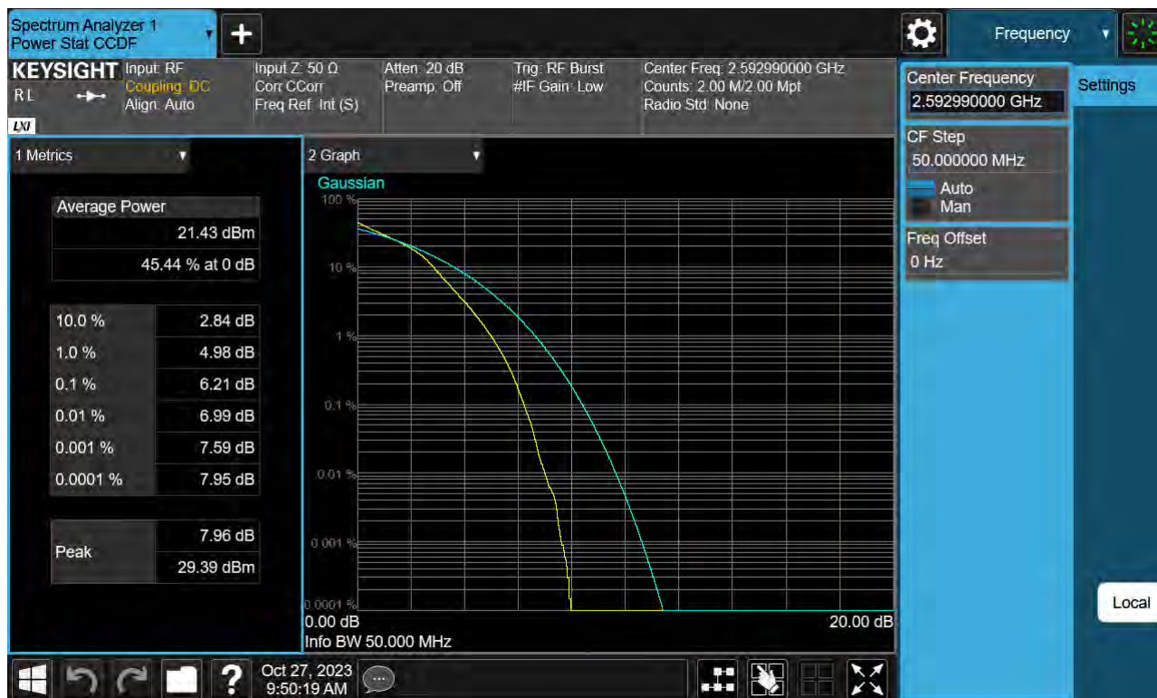
Sub6 n41. PAR Plot (50 M BW_Ch.518598_16QAM)
