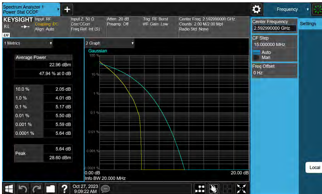
Sub6 n41. PAR Plot (20 M BW_Ch.518598_BPSK)
