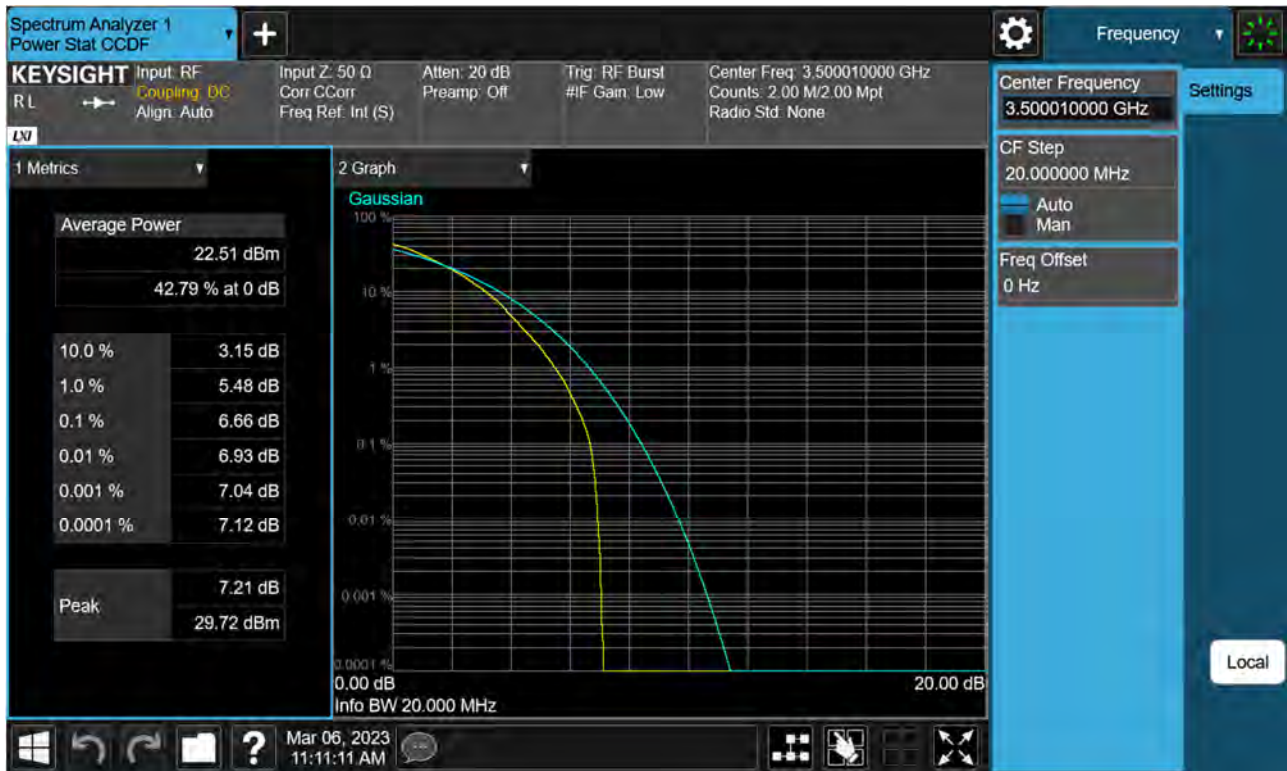
Sub6 n77(78). PAR Plot (20 M BW_Ch.633334_64QAM)
