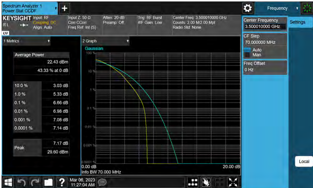
Sub6 n77(78). PAR Plot (70 M BW_Ch.633334_64QAM)
