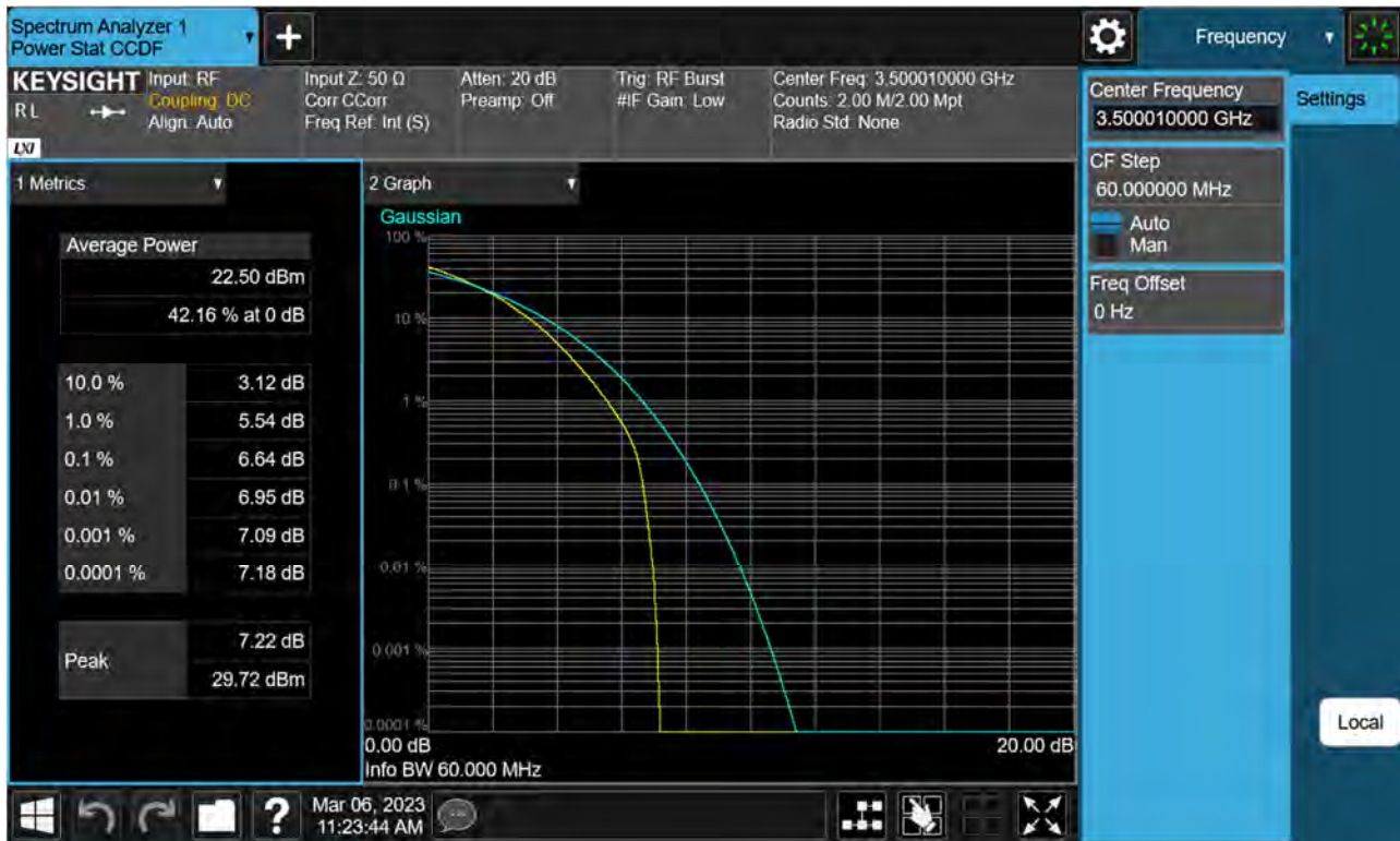
Sub6 n77(78). PAR Plot (60 M BW_Ch.633334_64QAM)
