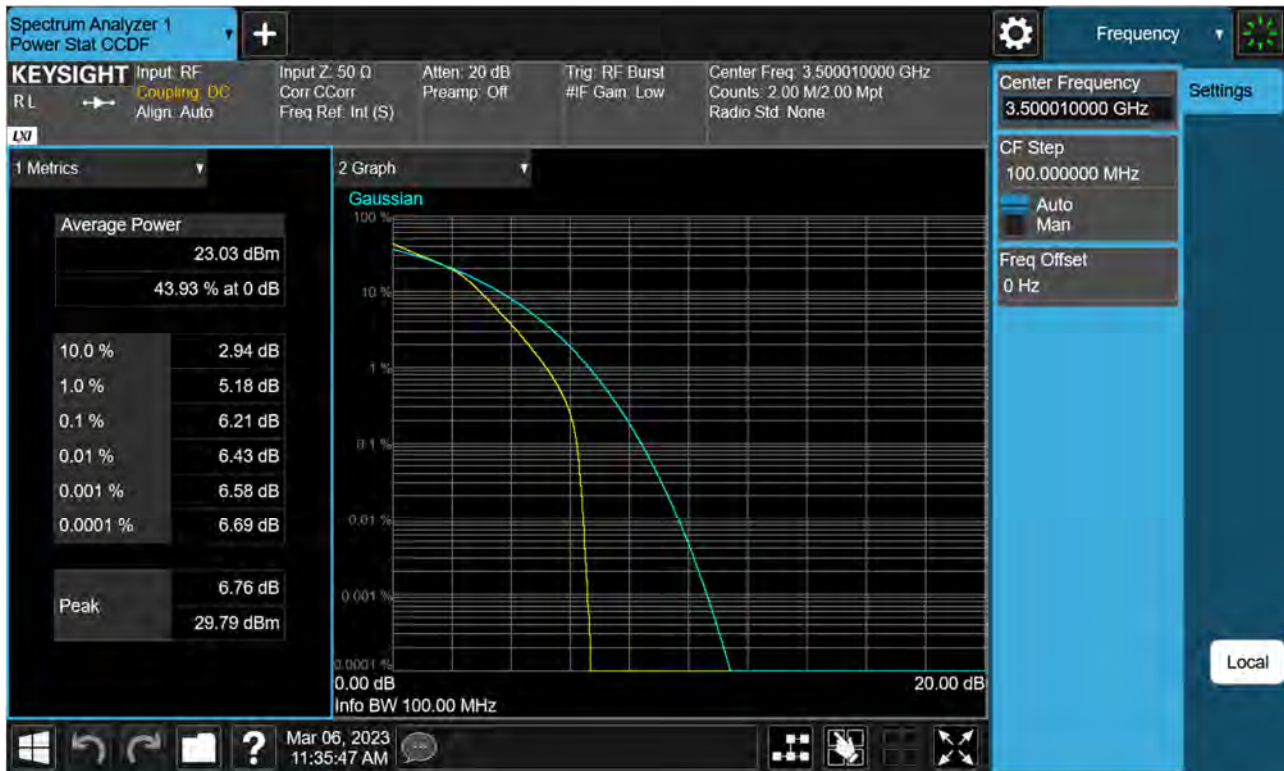
Sub6 n77(78). PAR Plot (100 M BW_Ch.633334_16QAM)
