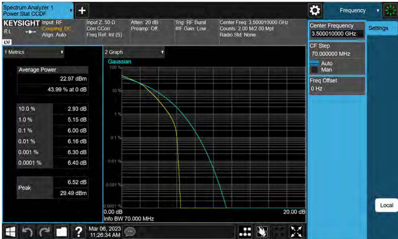
Sub6 n77(78). PAR Plot (70 M BW_Ch.633334_16QAM)
