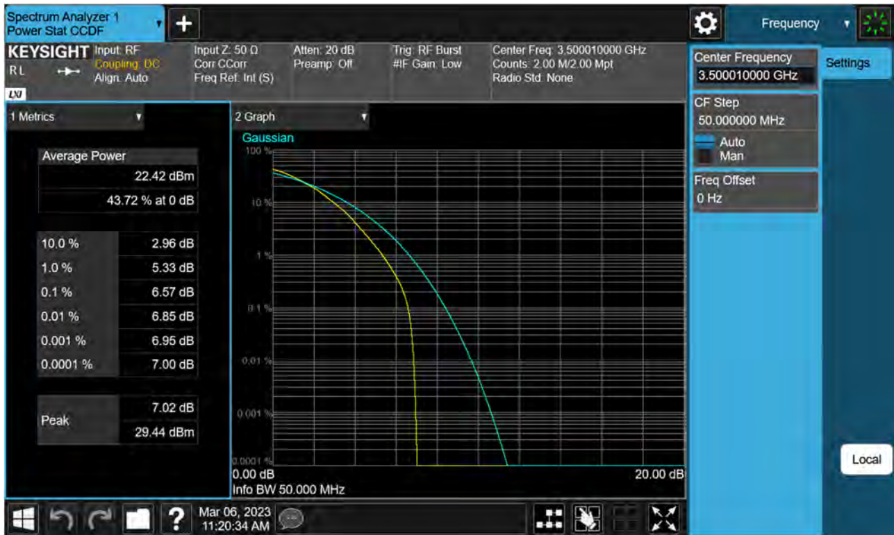
Sub6 n77(78). PAR Plot (50 M BW_Ch.633334_64QAM)
