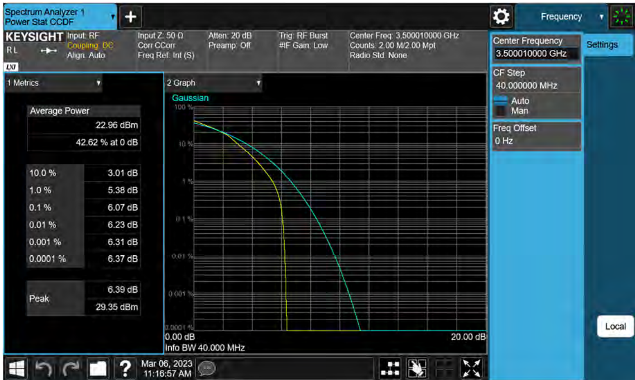
Sub6 n77(78). PAR Plot (40 M BW_Ch.633334_16QAM)
