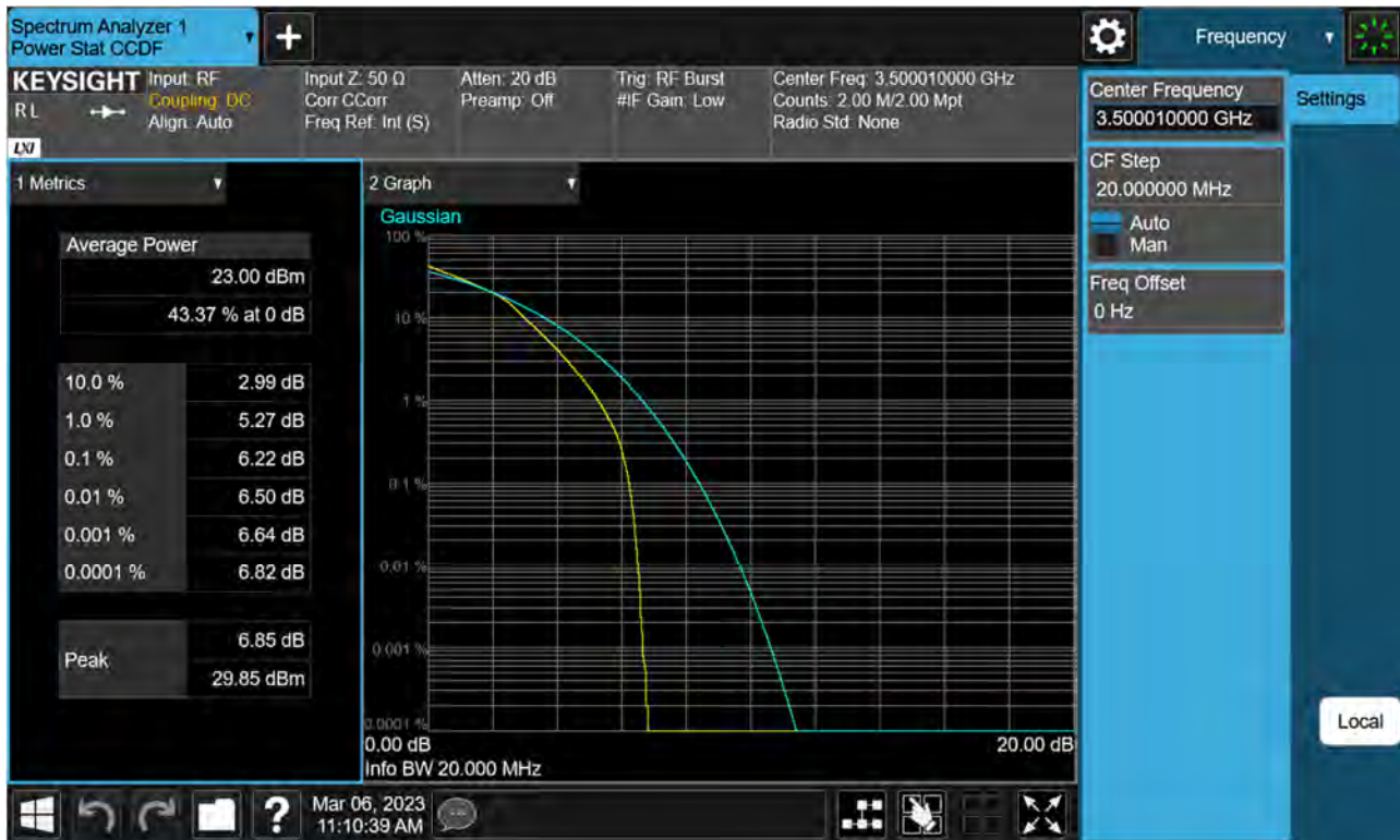
Sub6 n77(78). PAR Plot (20 M BW_Ch.633334_16QAM)
