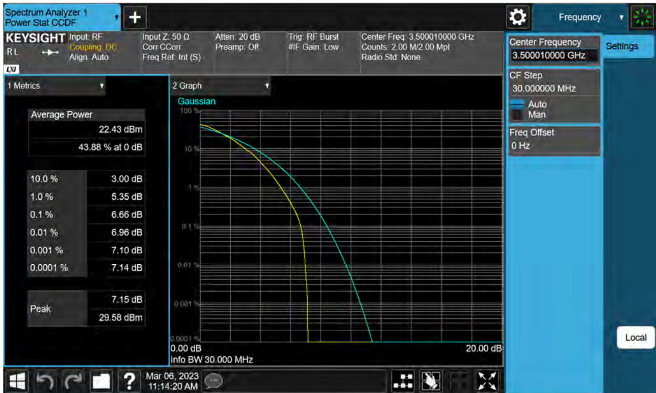
Sub6 n77(78). PAR Plot (30 M BW_Ch.633334_64QAM)
