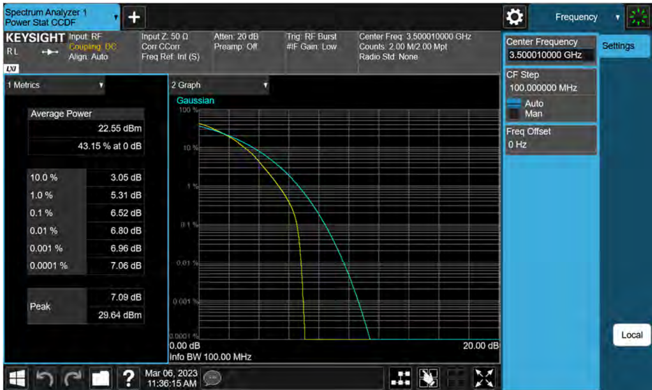
Sub6 n77(78). PAR Plot (100 M BW_Ch.633334_64QAM)
