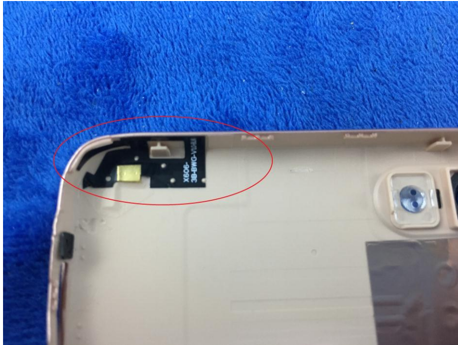
BT/WIFI/BLE/GPS - Antenna View
