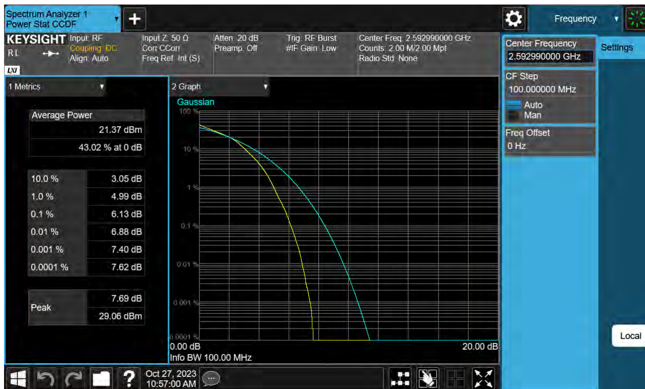
Sub6 n41. PAR Plot (100 M BW_Ch.518598_16QAM)
