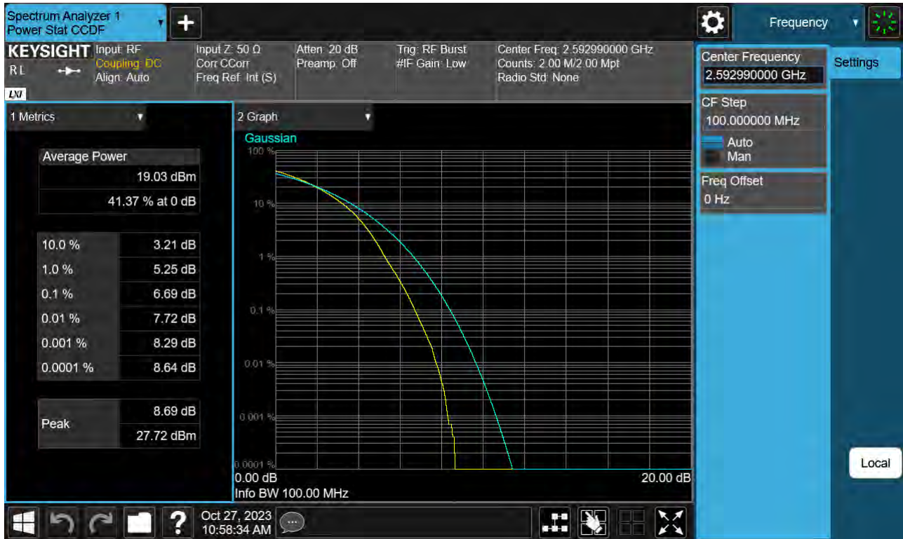
Sub6 n41. PAR Plot (100 M BW_Ch.518598_256QAM)
