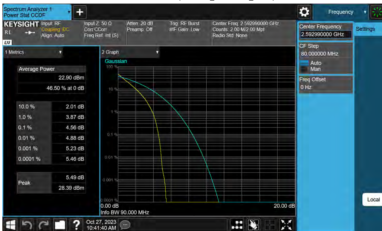
Sub6 n41. PAR Plot (90 M BW_Ch.518598_BPSK)
