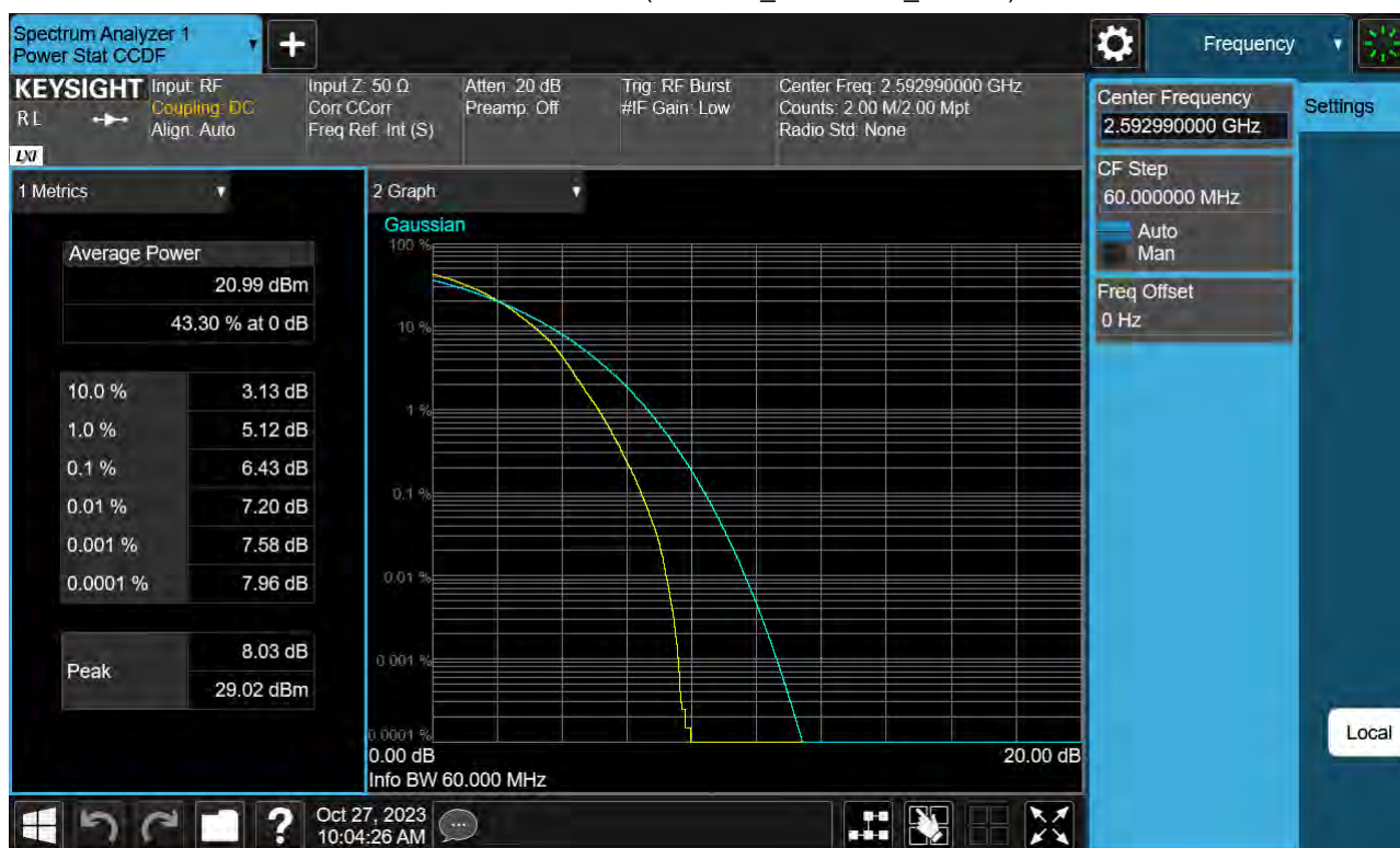
Sub6 n41. PAR Plot (60 M BW_Ch.518598_64QAM)
