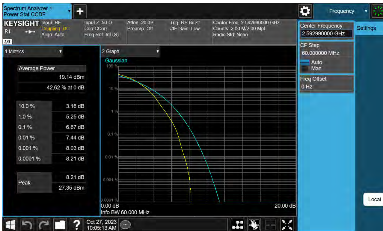
Sub6 n41. PAR Plot (60 M BW_Ch.518598_256QAM)
