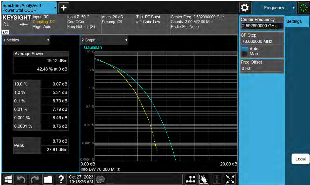
Sub6 n41. PAR Plot (70 M BW_Ch.518598_256QAM)
