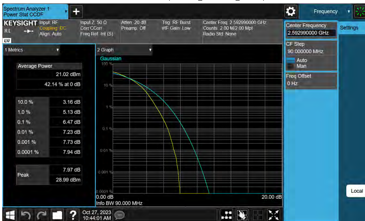
Sub6 n41. PAR Plot (90 M BW_Ch.518598_64QAM)
