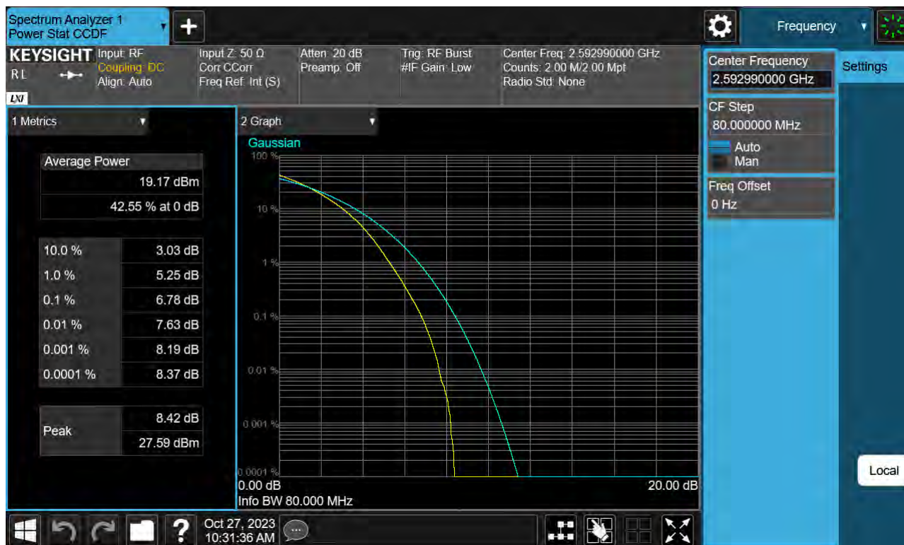
Sub6 n41. PAR Plot (80 M BW_Ch.518598_256QAM)
