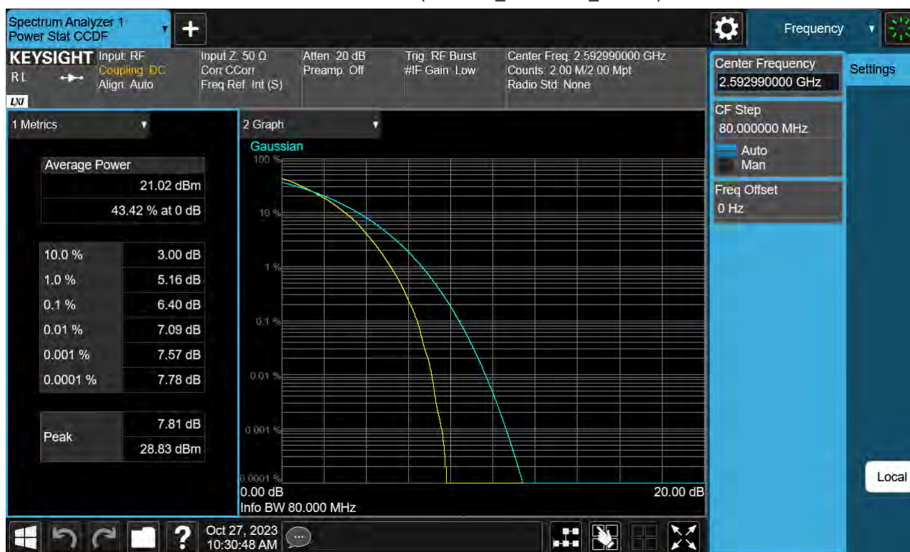
Sub6 n41. PAR Plot (80 M BW_Ch.518598_64QAM)
