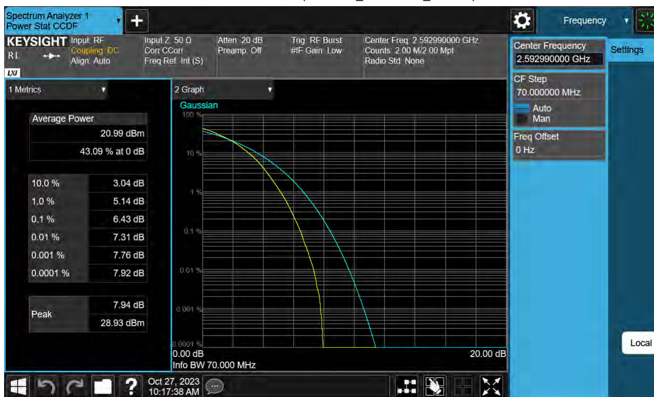
Sub6 n41. PAR Plot (70 M BW_Ch.518598_64QAM)
