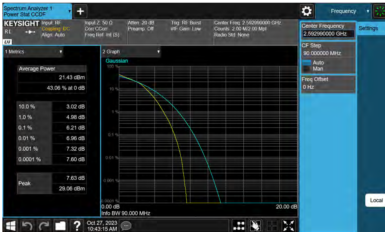
Sub6 n41. PAR Plot (90 M BW_Ch.518598_16QAM)
