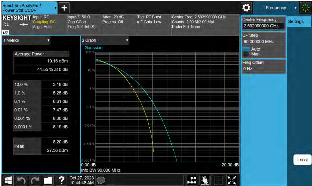
Sub6 n41. PAR Plot (90 M BW_Ch.518598_256QAM)
