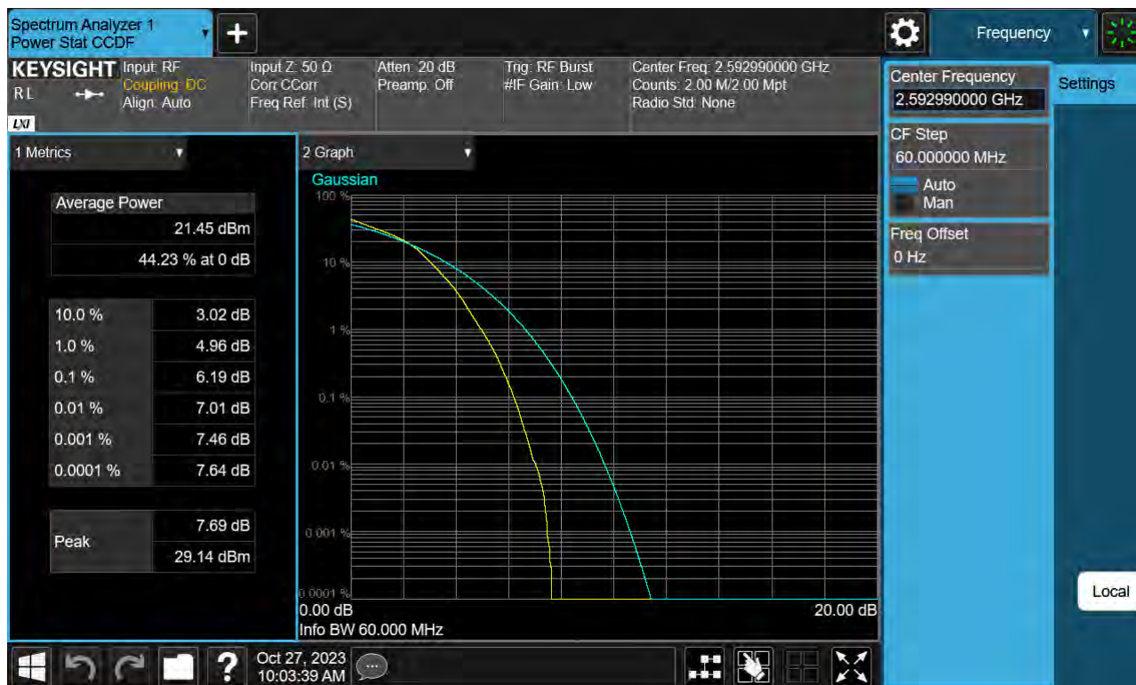
Sub6 n41. PAR Plot (60 M BW_Ch.518598_16QAM)
