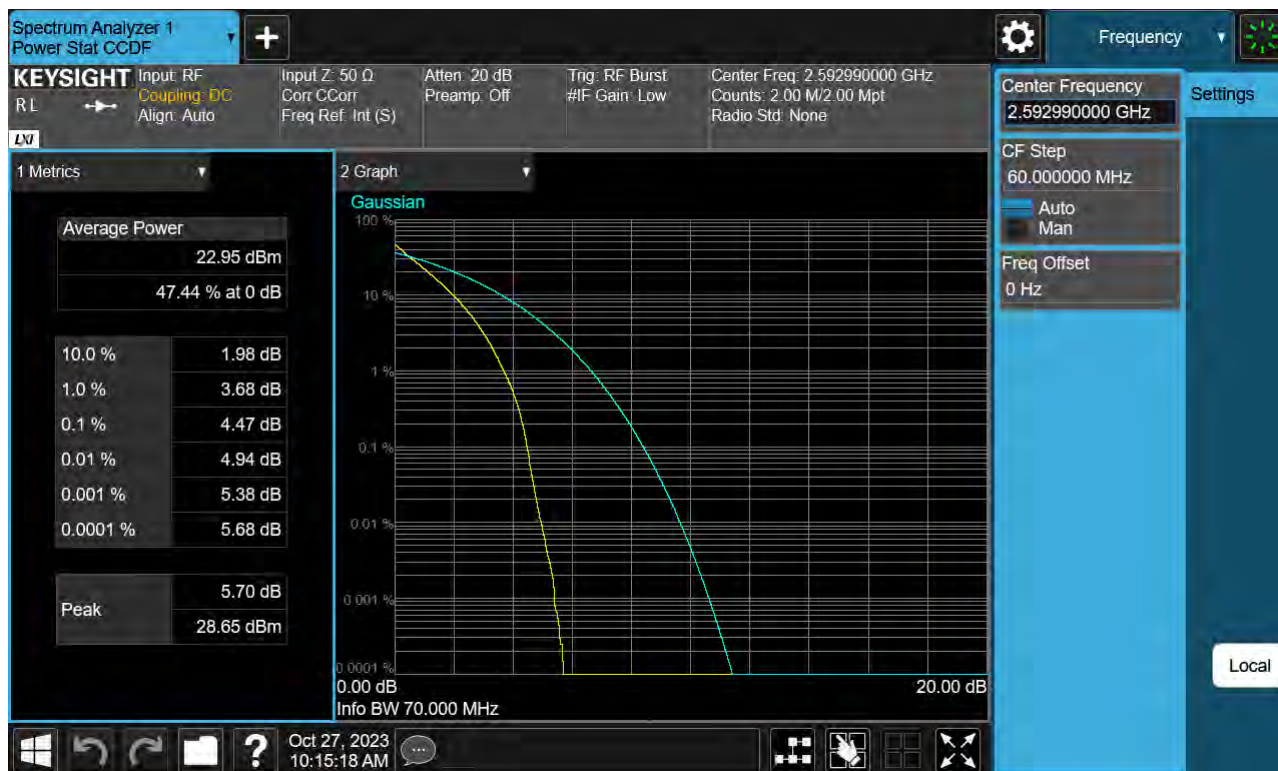
Sub6 n41. PAR Plot (70 M BW_Ch.518598_BPSK)
