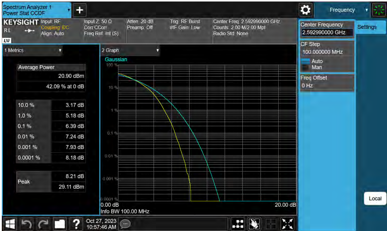
Sub6 n41. PAR Plot (100 M BW_Ch.518598_64QAM)
