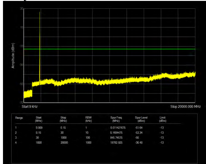
Band2 QPSK BW=15MHz Channel=19125 RB Size=1 Position=#0
