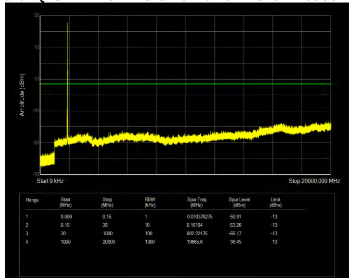
Band2 QPSK BW=20MHz Channel=18700 RB Size=1 Position=#0
