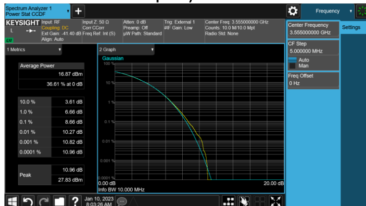
10+10MHz BW, TM3.2 Channel Frequency 3555+3695MHz
