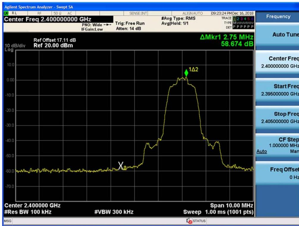
Test Plots without hopping ( $\pi/4$ DQPSK)
