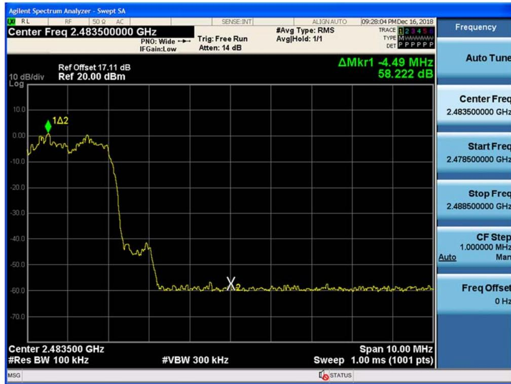
Test Plots with hopping ( $\pi/4$ DQPSK)
