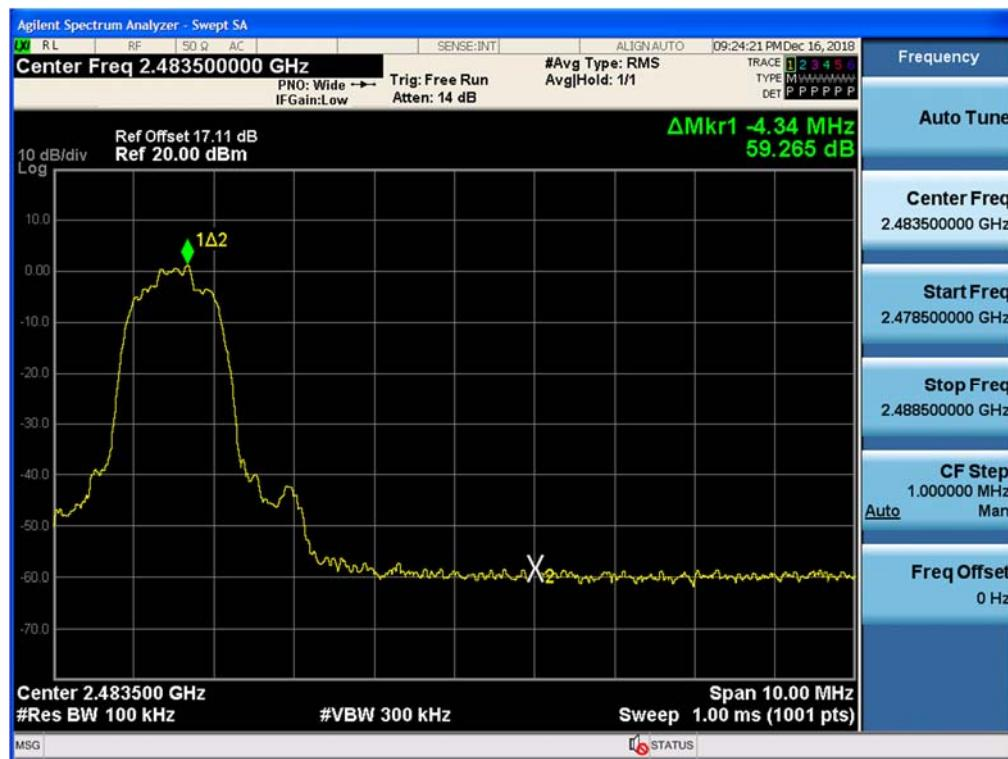
Test Plots without hopping ( $\pi/4$ DQPSK)
