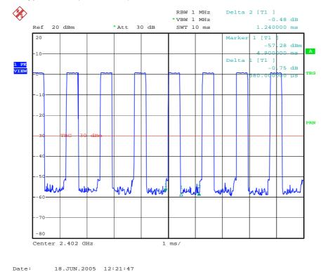
DH1 Modulation Type: GFSK (Channel 00) :
