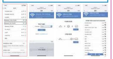
机扩展后名称可以修改,继续下一步直到显示配置成功,返回手机或电脑选择扩展后WiFi连接上网,也可以通过LAN口网线连接电脑直接上网。
