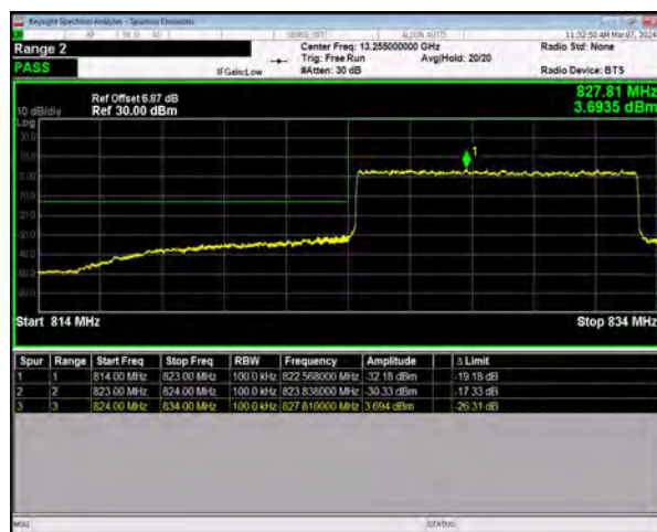
n5 SCS=15kHz DFT_QPSK BW=10MHz LowChannel=165800 RB=50@0
