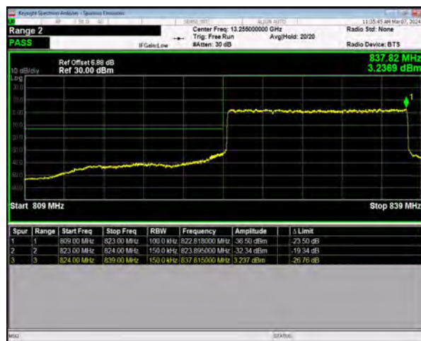
n5 SCS=15kHz DFT_BPSK BW=15MHz LowChannel=166300 RB=75@0
