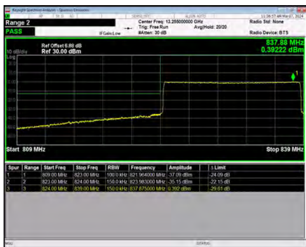
n5 SCS=15kHz CP_QPSK BW=15MHz LowChannel=166300 RB=79@0
