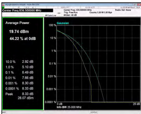
n5 SCS=15kHz DFT_256QAM BW=20MHz Channel=167300 RB=100@0
