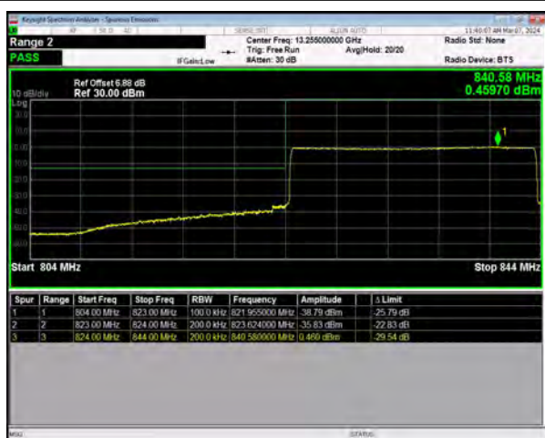
n5 SCS=15kHz CP_QPSK BW=20MHz LowChannel=166800 RB=106@0
