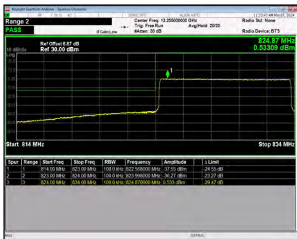
n5 SCS=15kHz CP_QPSK BW=10MHz LowChannel=165800
