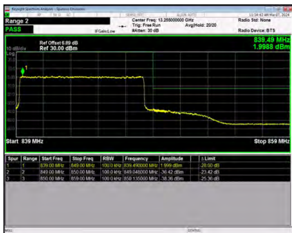
n5 SCS=15kHz DFT_16QAM BW=10MHz HighChannel=168800 RB=50@0
