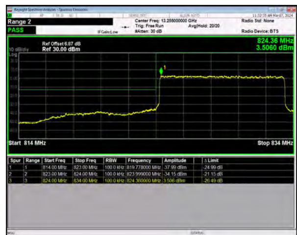
n5 SCS=15kHz DFT_BPSK BW=10MHz LowChannel=165800 RB=50@0
