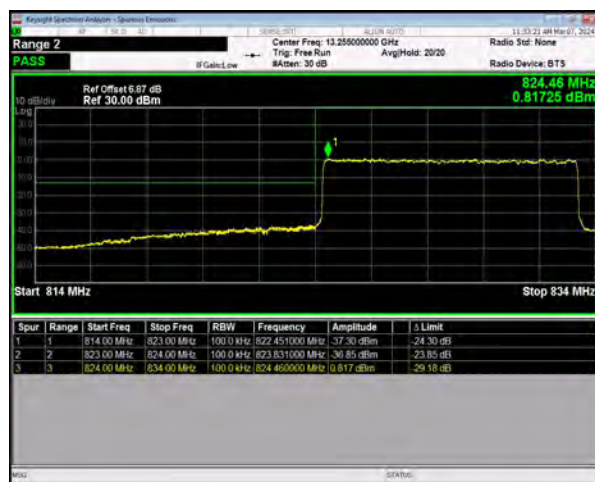
n5 SCS=15kHz DFT_64QAM BW=10MHz LowChannel=165800 RB=50@0
