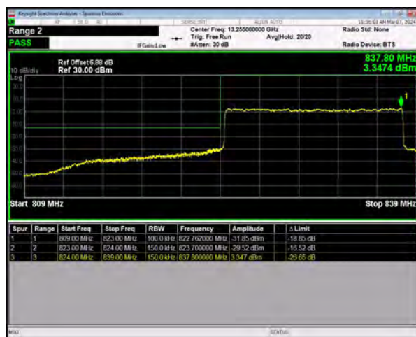
n5 SCS=15kHz DFT_QPSK BW=15MHz LowChannel=166300 RB=75@0
