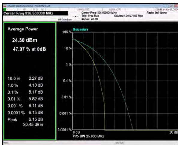
n5 SCS=15kHz DFT_QPSK BW=20MHz Channel=167300 RB=100@0
