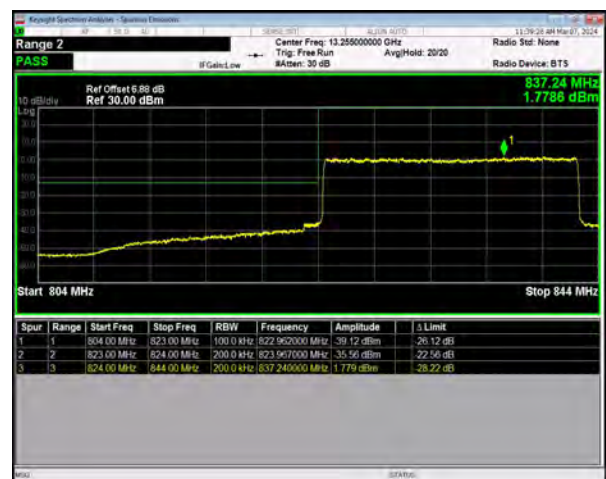
n5 SCS=15kHz DFT_16QAM BW=20MHz LowChannel=166800 RB=100@0
